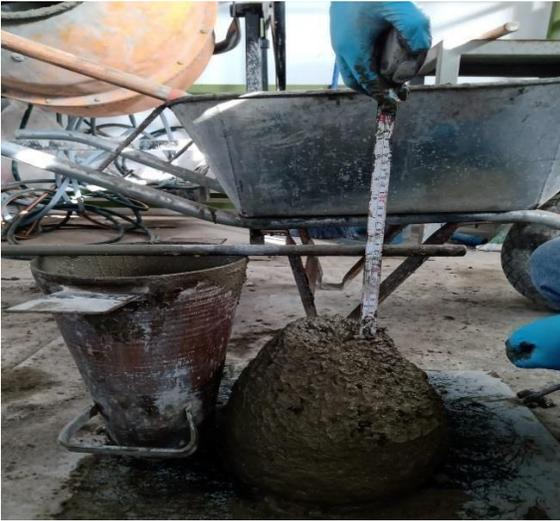
Figura N° 5: Slump de cemento Apu 4".
