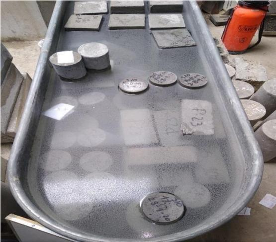
Figura N° 11: Curado de probetas cilíndricas.
