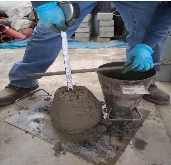
Figura N° 7: Slump de cemento Quisqueya 4".
