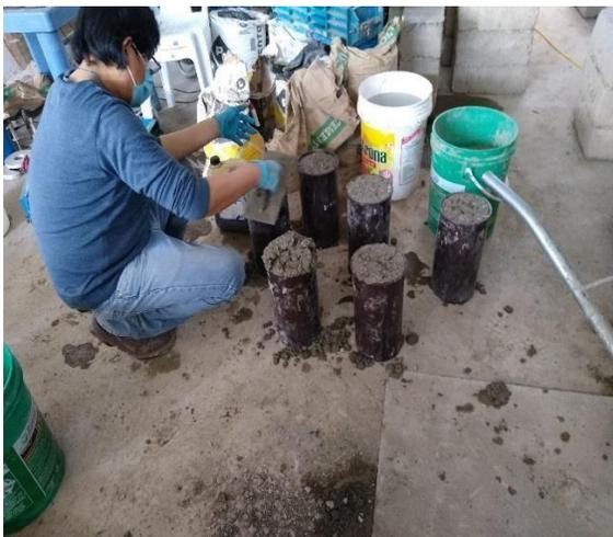
Figura N° 9: Vaciado de 3era capa en probeta.
