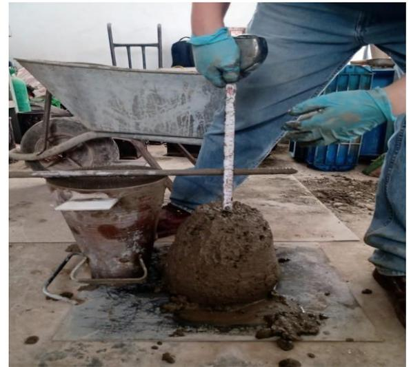
Figura N° 8: Slump de cemento Andino 4 ¾".
