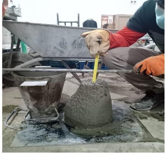
Figura N° 6: Slump de cemento Sol 4".
