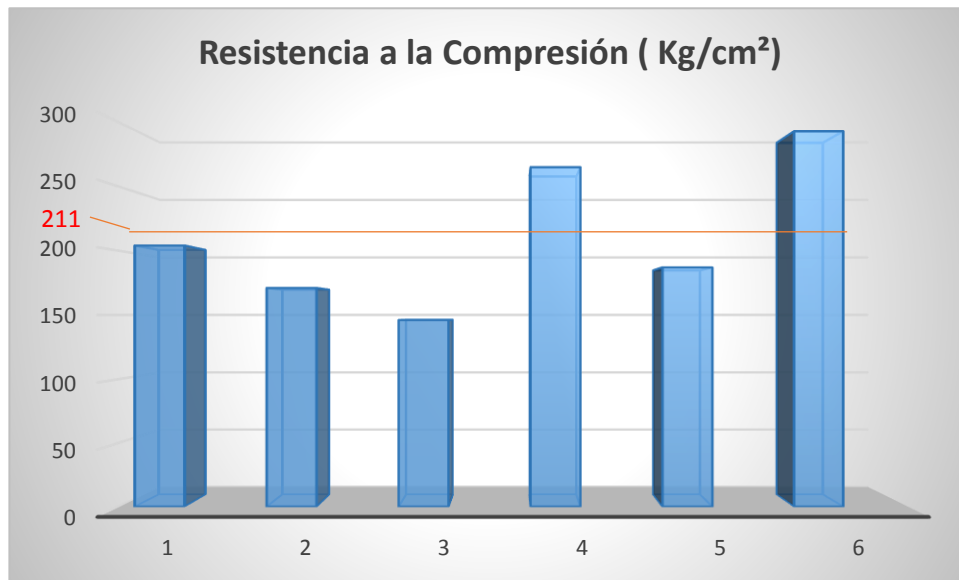
Gráfico N° 19: Promedio obtenido de ensayo de resistencia a la compresión
