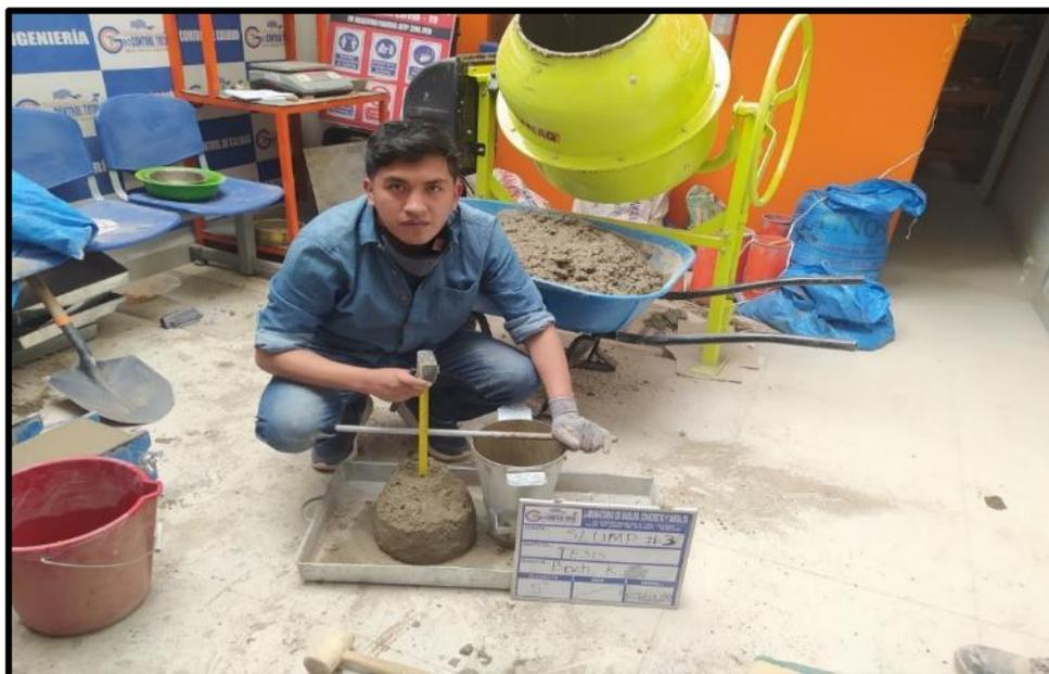
Figura 30. Realizando el ensayo de Slump antes de su vaciado.
