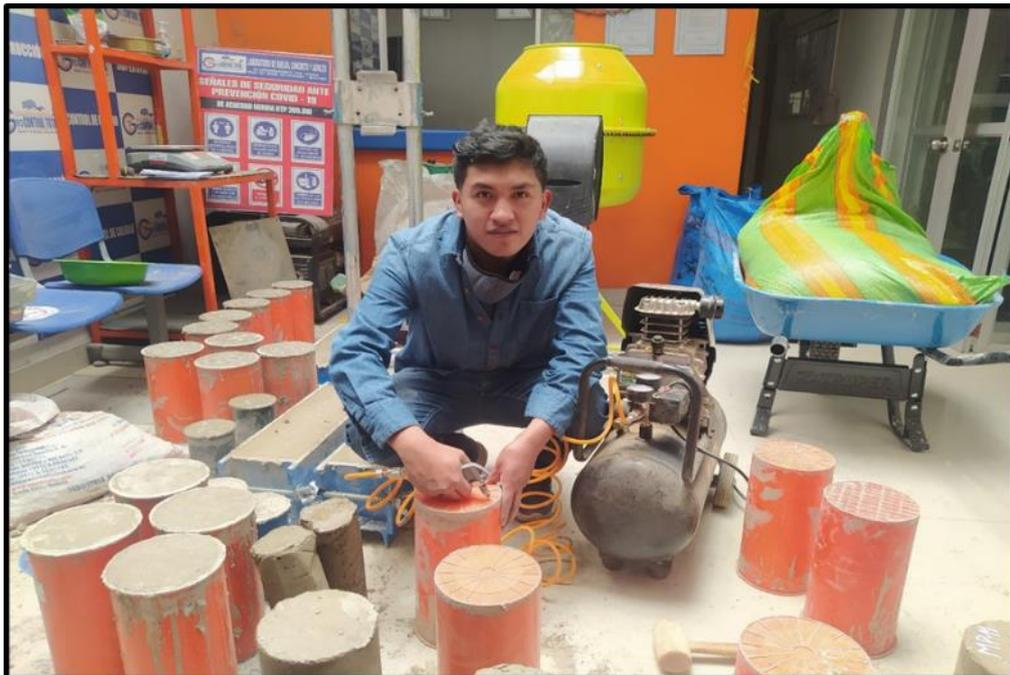
Figura 23. Desencofrado de las probetas con ayuda de una compresora de aire.
