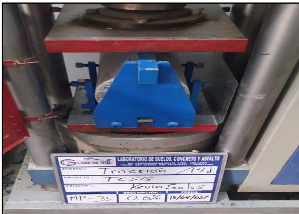
Figura 37. Ensayo a la tracción
