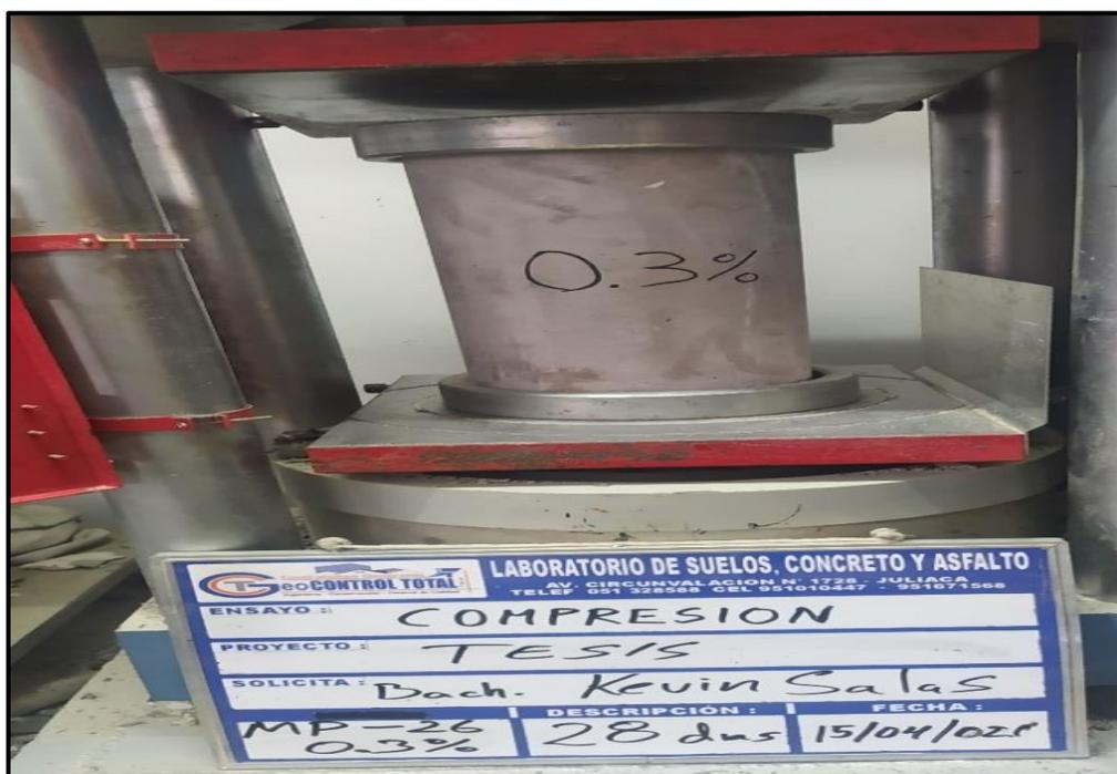
Figura 34. Ensayo a compresión
