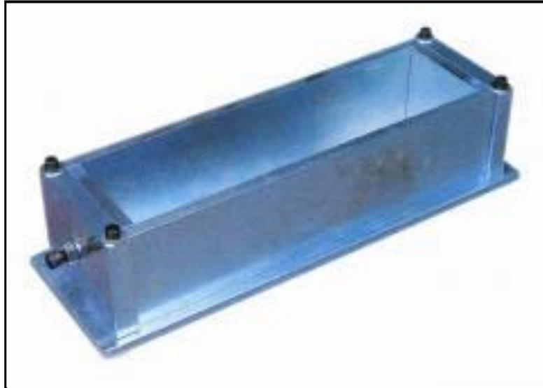
Figura 8. Molde para fabricación de probetas prismáticas.
