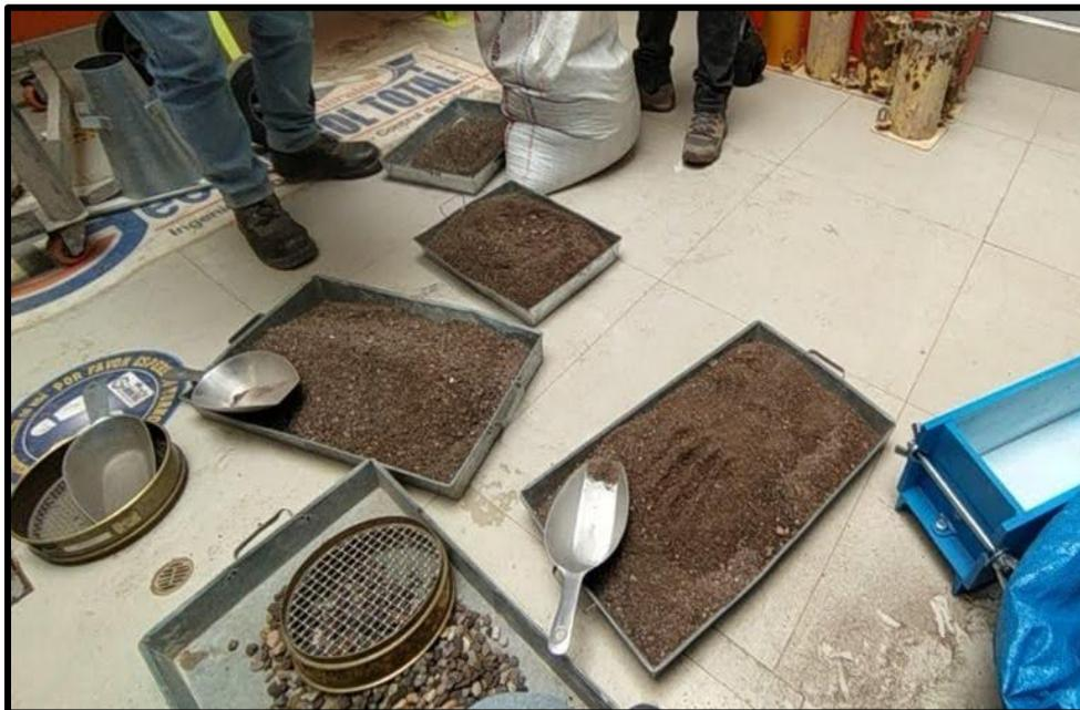
Figura 19. Dosificación y pesaje a usar para la mezcla.
