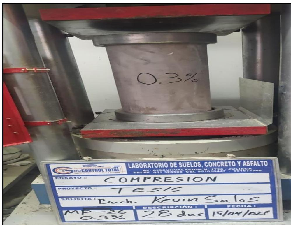
Figura 31. Ensayo a la compresión
