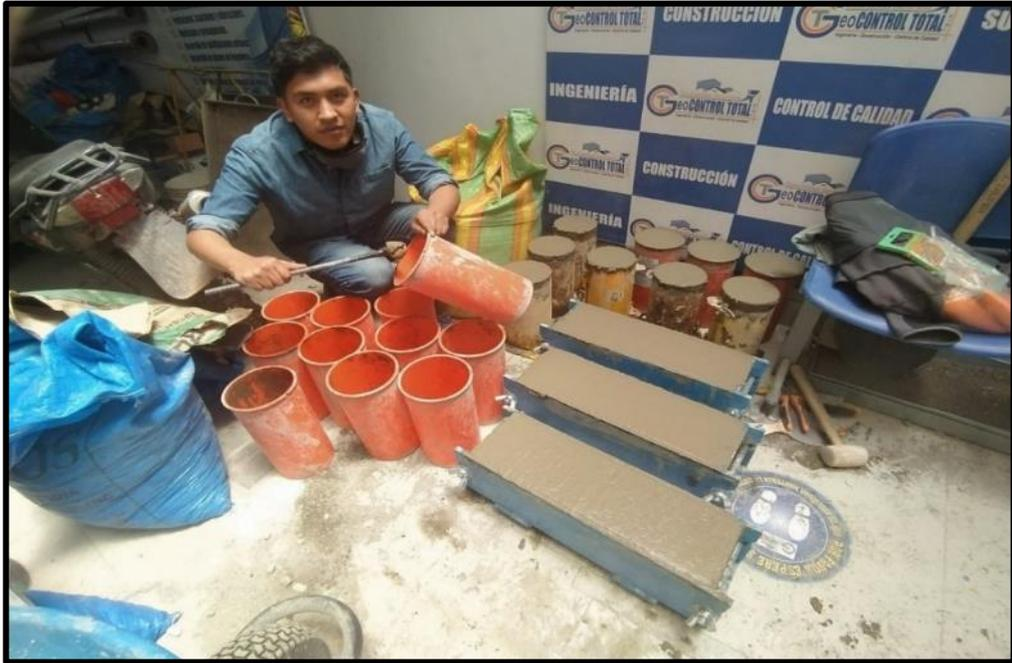
Figura 26. Lubricación de los moldes de probetas y vigas.
