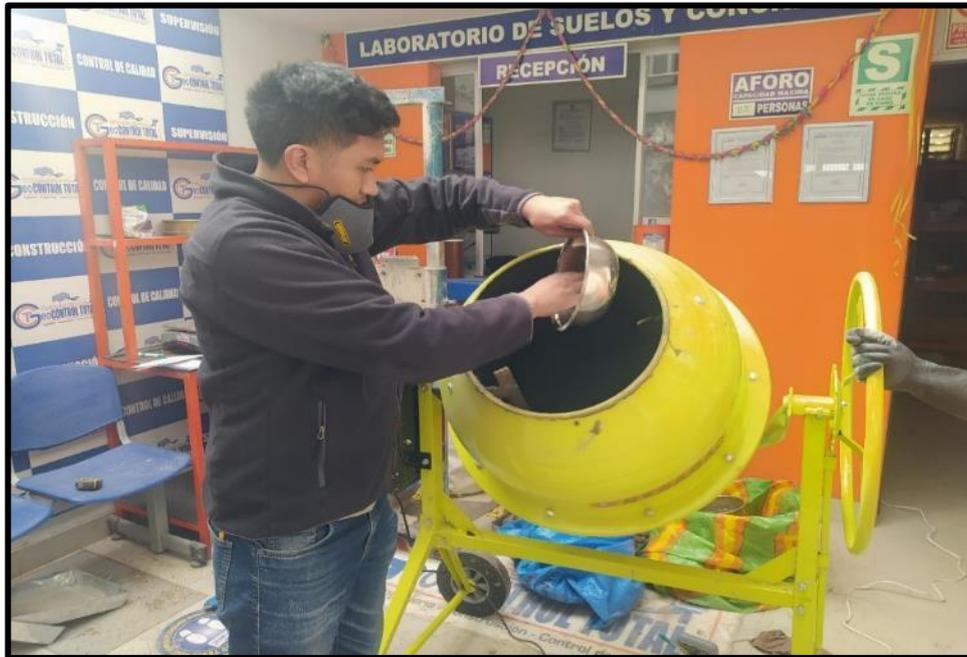
Figura 29. Agregando la fibra a la mezcladora para su mayor homogeneidad.
