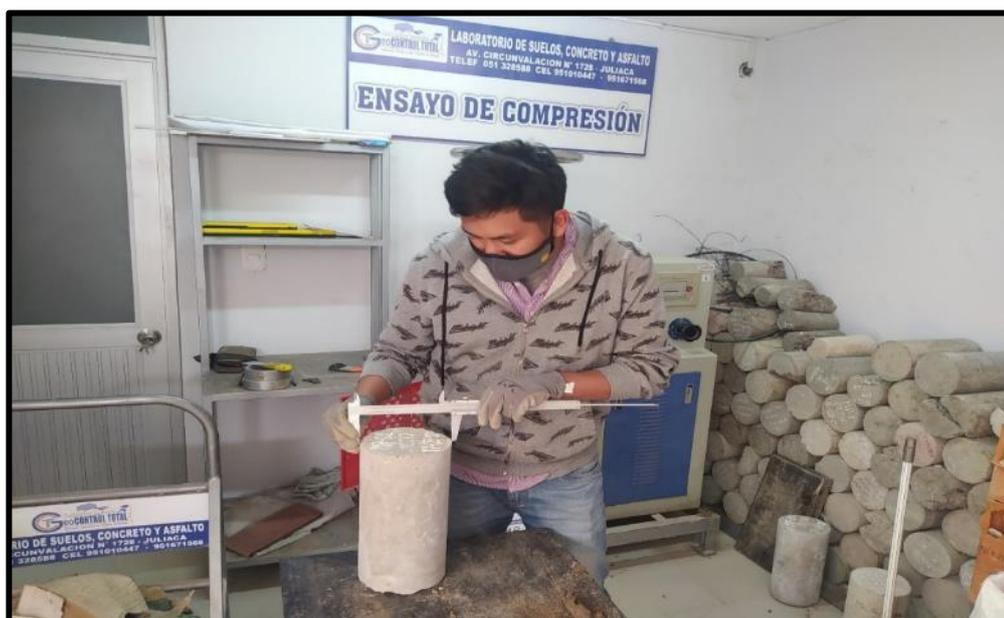
Figura 45. Obtención de medidas de las probetas y vigas previa a su rompimiento.
