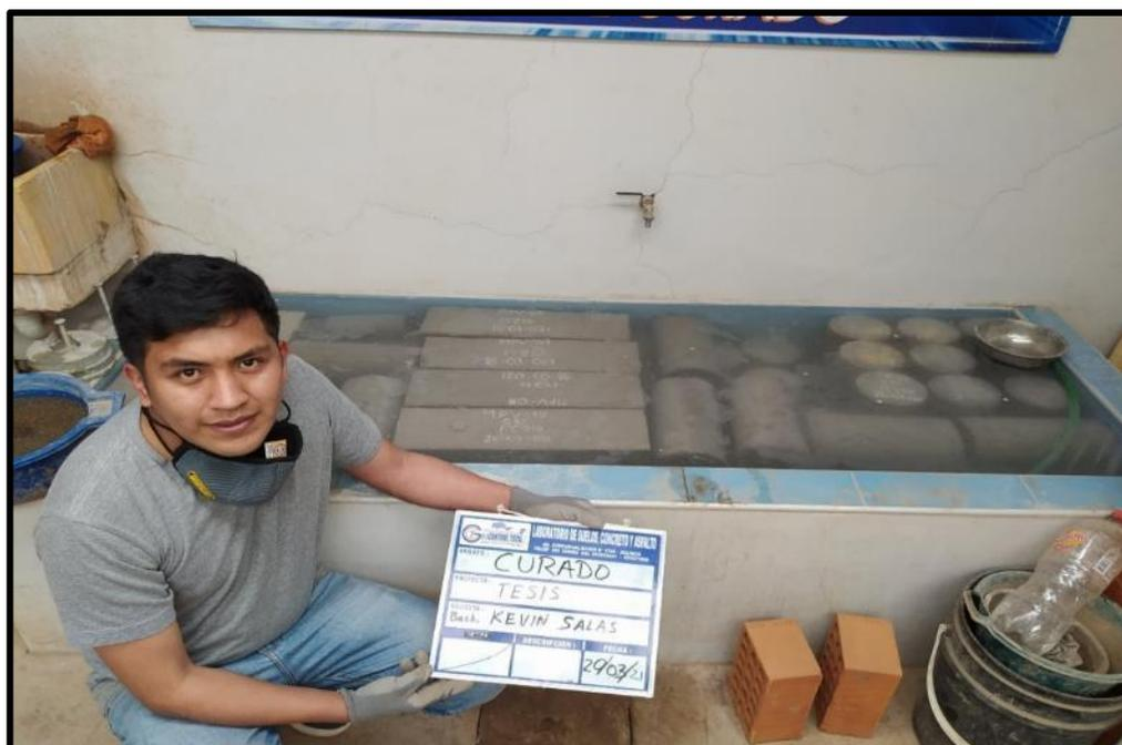
Figura 44. Curado de la probetas y vigas 7,14,28 días.
