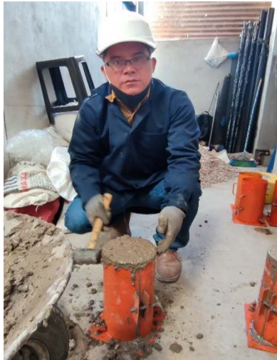
Figura 24: Preparado de probetas Fuente: Elaboración propia
