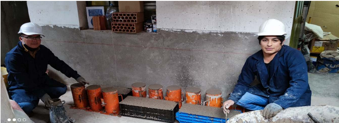
Foto N° 012 muestra las probetas cilíndricas para el ensayo a compresión y las probetas prismáticas para el ensayo a flexión.
