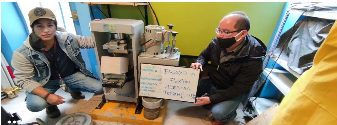
Foto N° 018 muestra el ensayo a flexión de la muestra patrona los 7 días.
