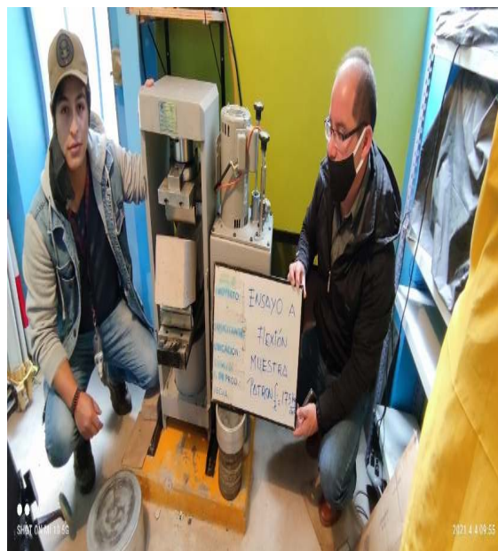
Figura 31: Rotura de muestra – flexión Fuente: Elaboración propia
