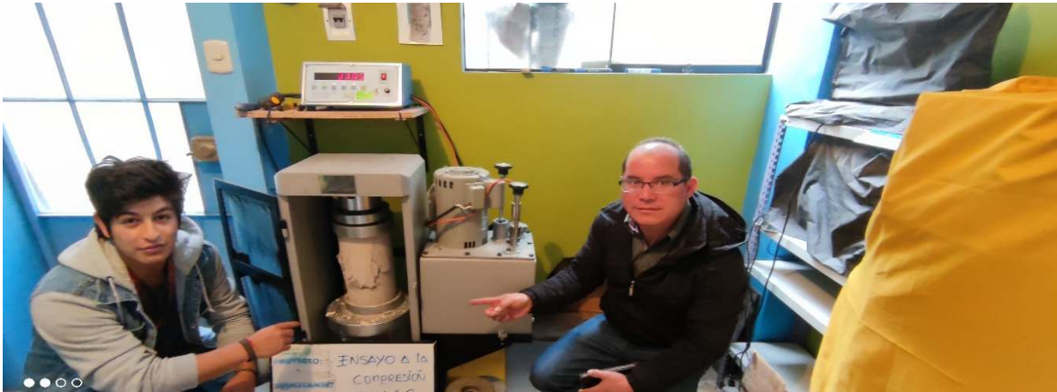
Foto N° 015 muestra el ensayo a la compresión del concreto a los 7 días.
