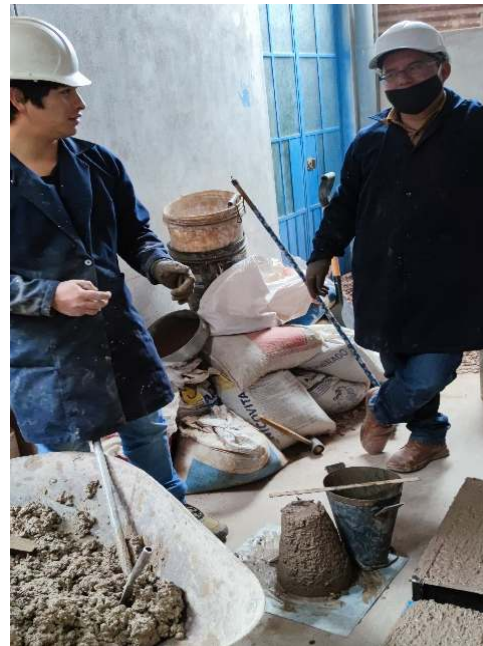
Figura 22: Obtención del SLUMP
