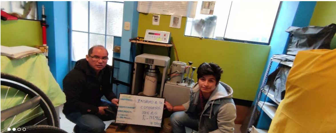
Foto N° 013 muestra el ensayo a la compresión del concreto a los 7 días.
