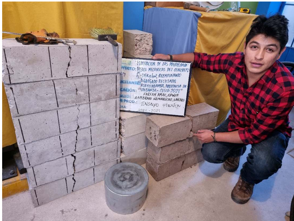
Foto N° 018 se aprecia la rotura de las muestras prismáticas en el ensayo a flexión del concreto.
