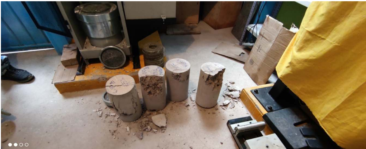
Foto N°016 muestra el tipo de falla en cada probeta para la resistencia a compresión
