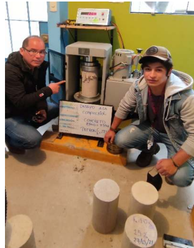
Figura 25: Rotura de briquetas Fuente: Elaboración propia
