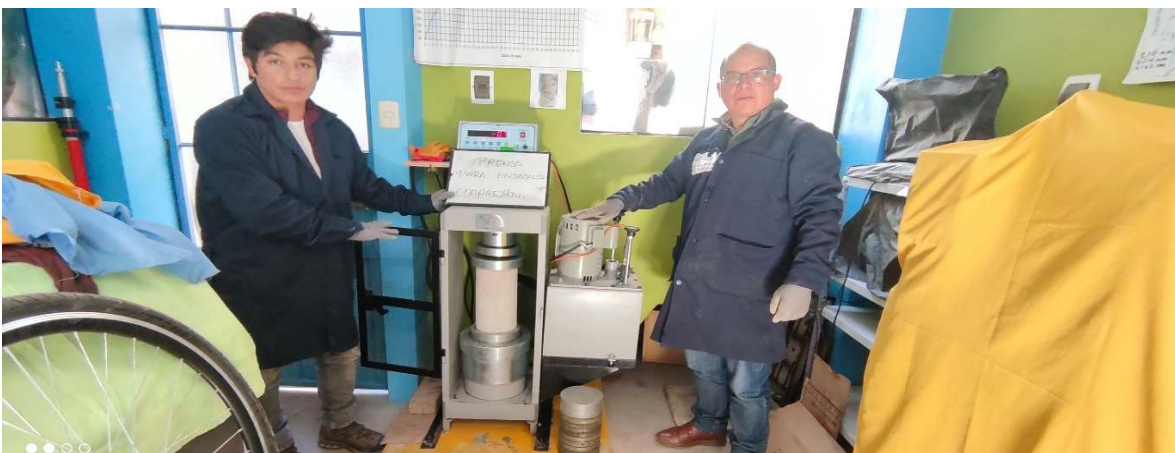
Foto N° 014 muestra el ensayo a la compresión del concreto a los 28 días.
