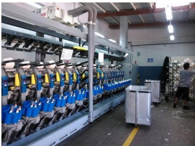
*Figura 15 Máquinas Coneras*
