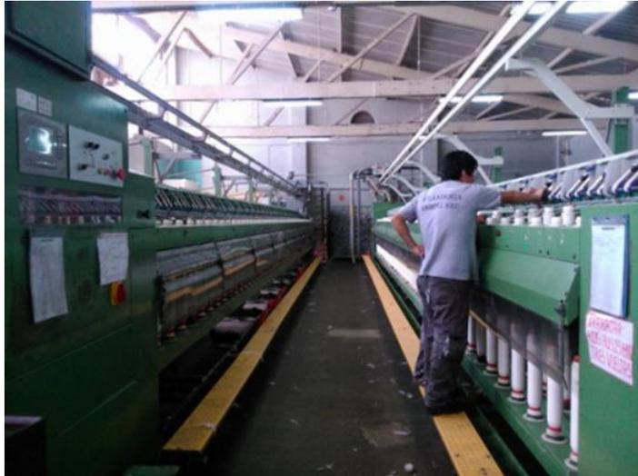
*Figura 13 Máquinas Mecheras*
