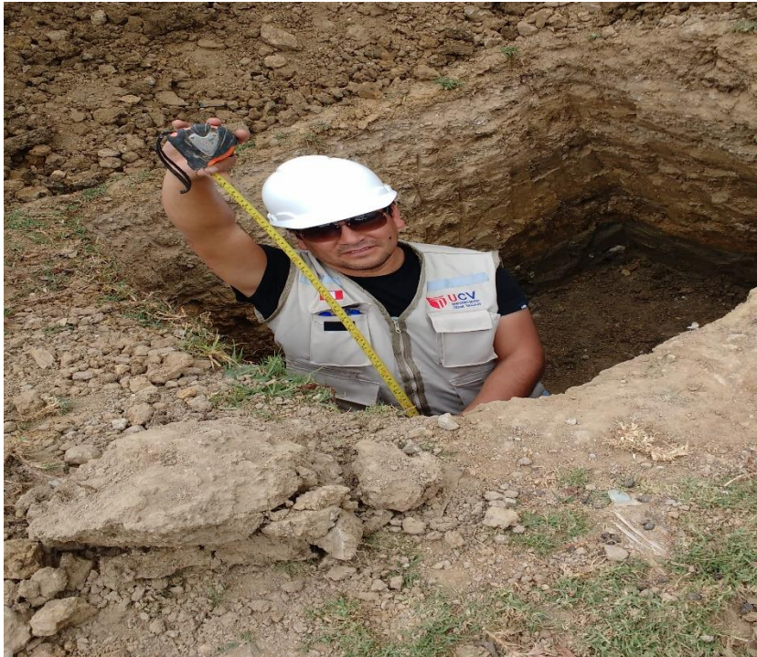
Foto N° 11: medición de la altura en la calicata C-5
