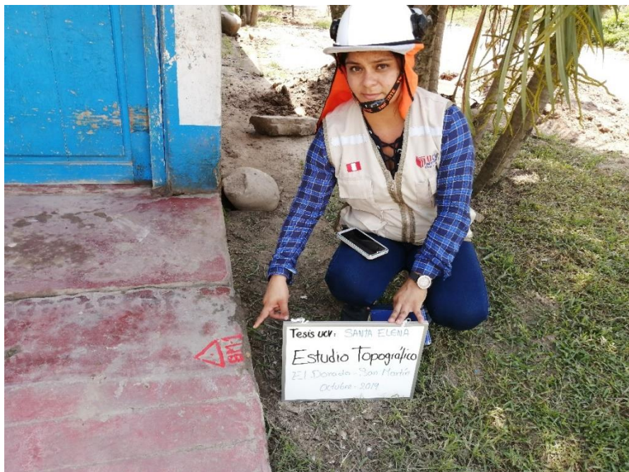
Foto N° 2: BMs de levantamiento topográfico
