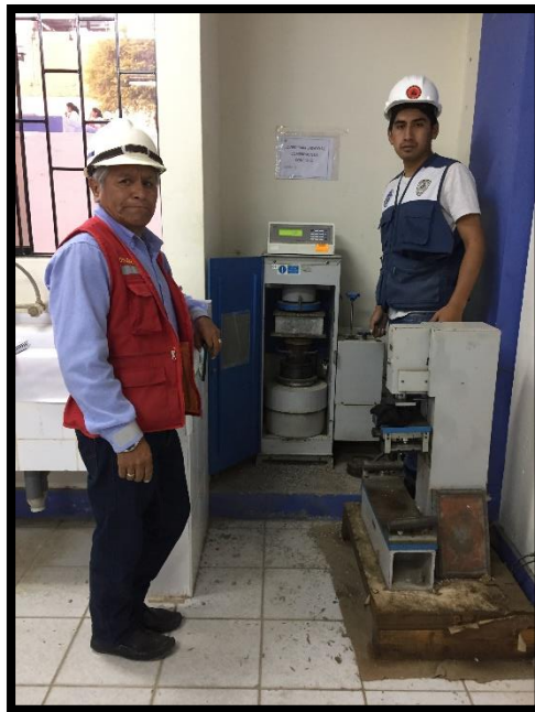
Figura 44. Ensayo de resistencia a la compresión supervisados por los ingenieros correspondientes.
