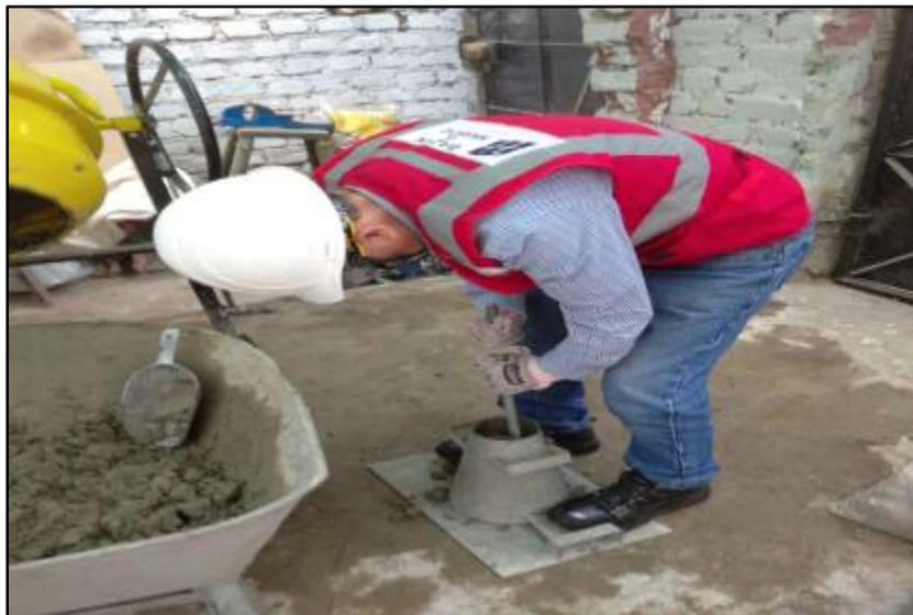
Figura 17. Toma del ensayo de revenimiento en el Laboratorio.
