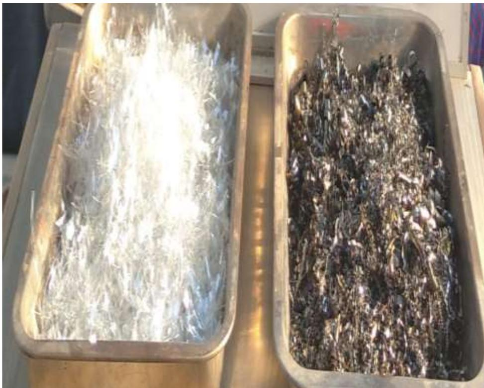
*Figura 2.* Fibras de polietilentereftalato y de acero reciclados.
