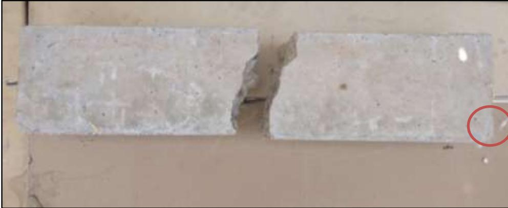
Figura 28. Obsérvese la fibra PET en los bordes de la probeta.
