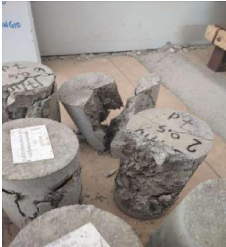
Foto N°18 Fractura de probetas en el Laboratorio
