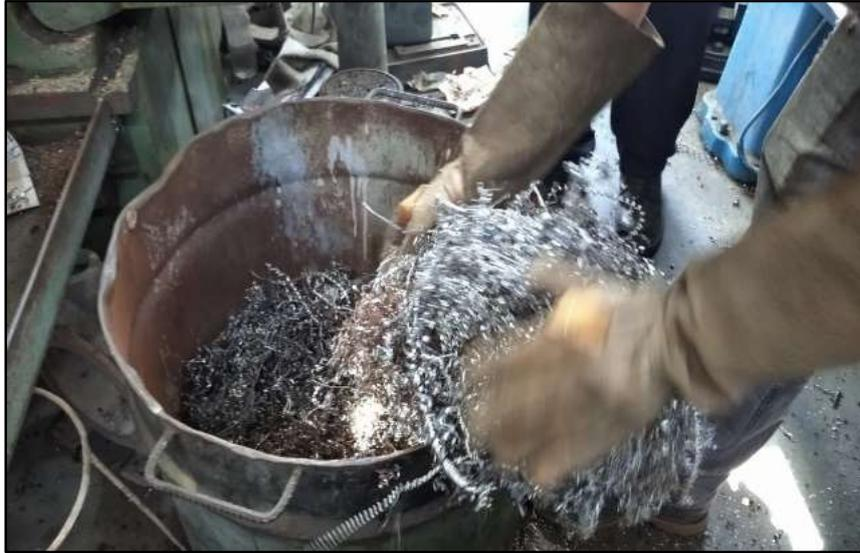
Figura 1. Fibras de acero recicladas del torno.
