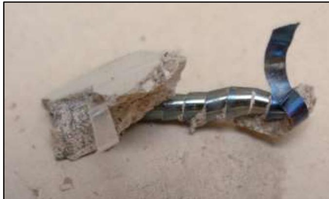
*Figura 27. La adherencia del concreto en la viruta.*
