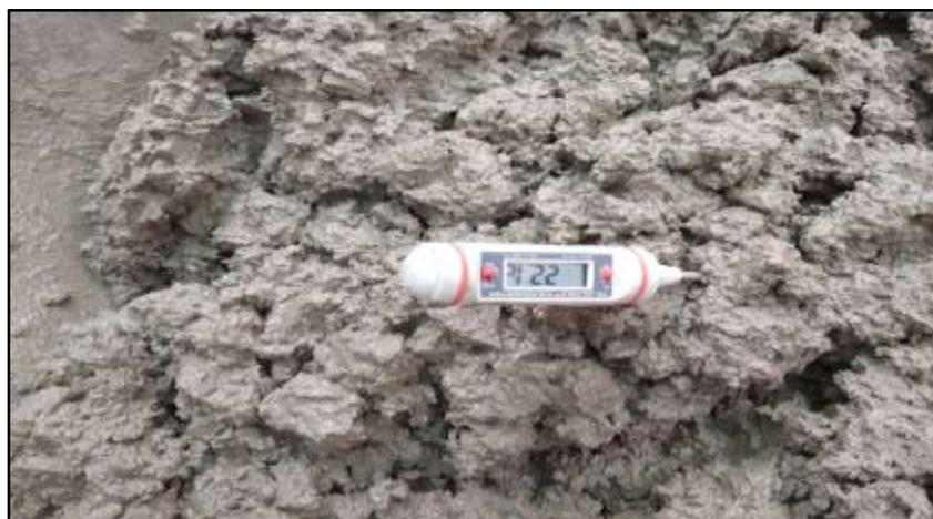
Figura 16. Toma de la temperatura de concreto fresco en el Laboratorio.
