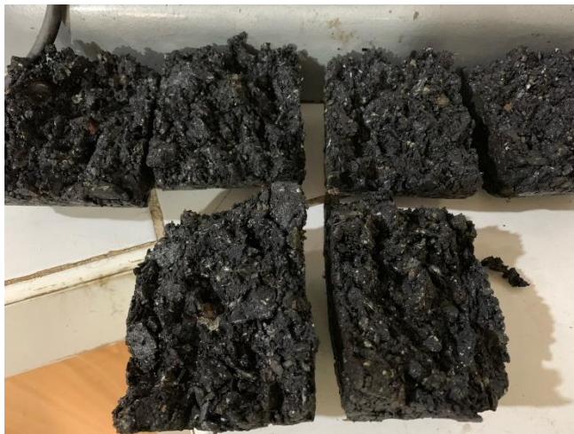
Figura 16. Rotura de Briquetas de ensayo para determinar sus propiedades.
