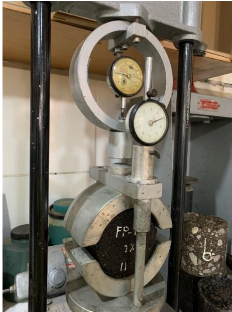
Figura 15. Ensayo Marshall usando la Mordaza Marshall.
