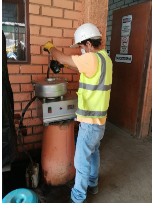
Figura 11. Lavado de la mezcla asfáltica antes del ensayo
