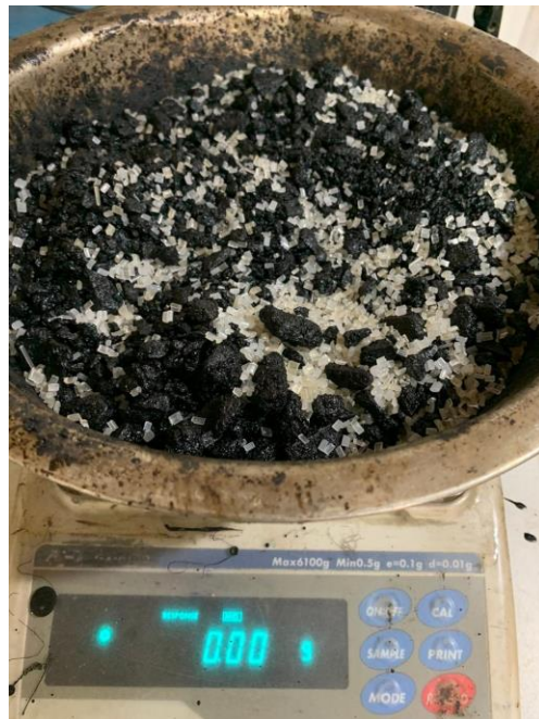
Figura 12. Dosificación mezcla asfáltica modificada.
