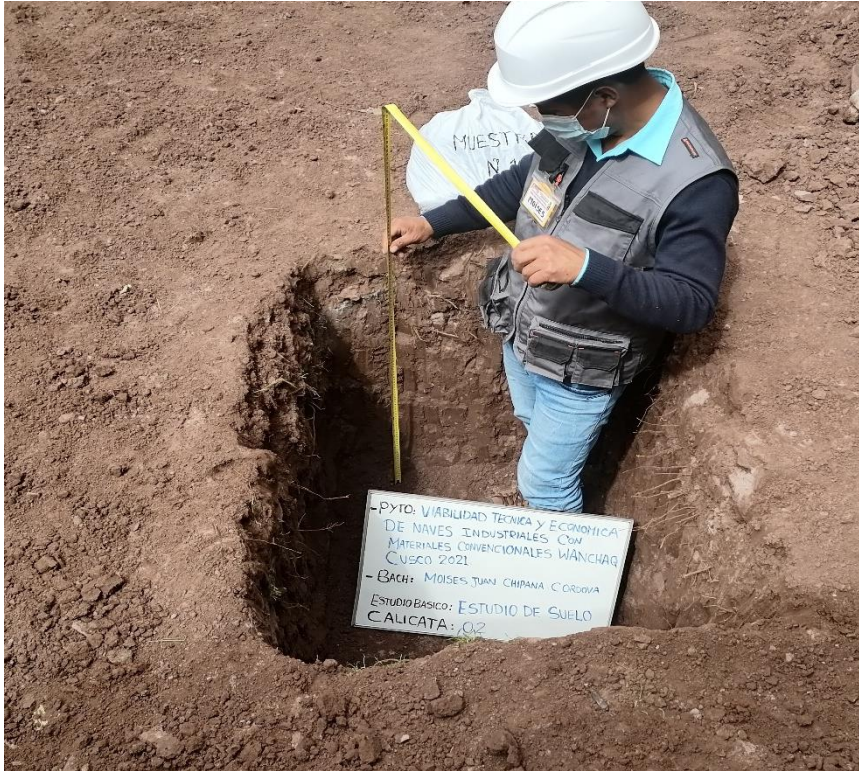
Figura 22.4 Control de profundidad de calcata y muestra de perfil estratigráfico del suelo.
