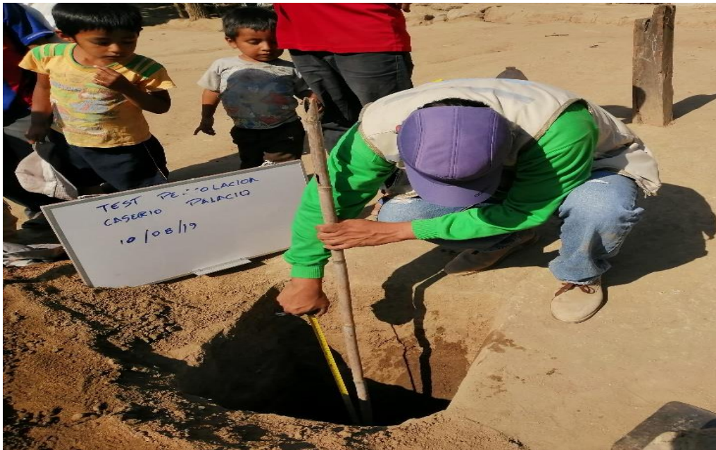
Foto N° 06. Test de Percolación en el caserío de Palacio.
