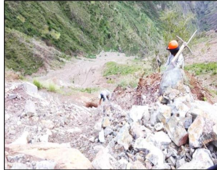
Imagen N°02.- Calicata 01, obtención de muestras.
