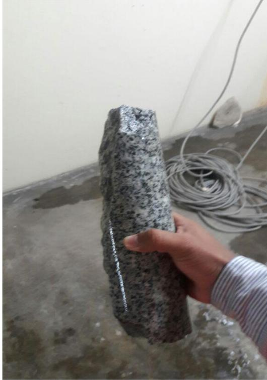
Figura 3.5. Testigo extraído del ensayo de diamantina
