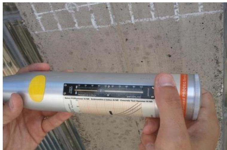
Figura 3.2.Toma de muestra con esclerómetro
