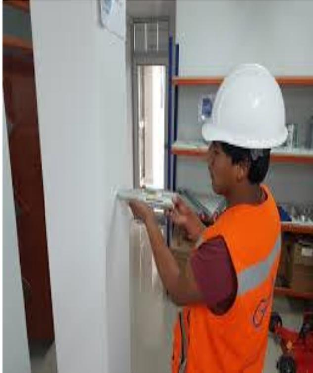
Figura 3.3.Toma de muestra con esclerómetro
