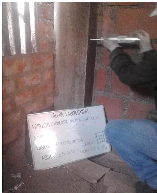
Figura 3.4.Toma de muestra con esclerómetro
