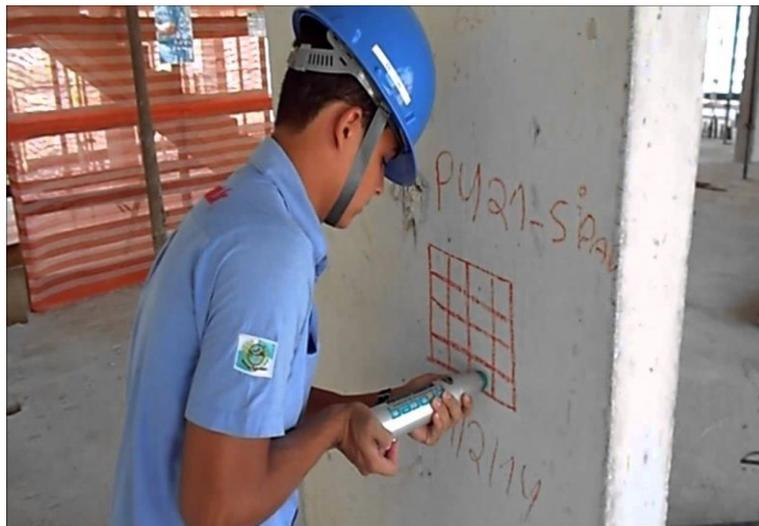
Figura 3.1.Toma de muestra con esclerómetro
