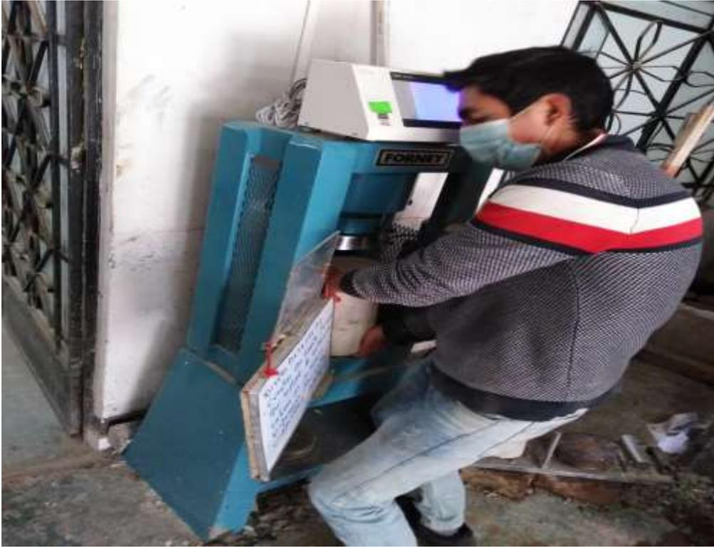
Anexo 23: Colocación de probeta para el ensayo de compresión
