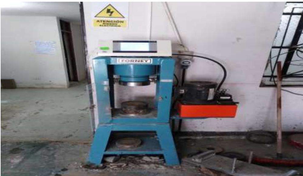
Anexo 22: Máquina de ensayo a compresión
