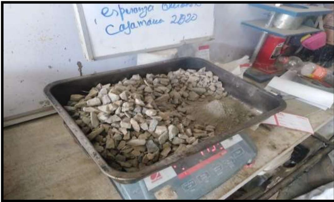
Anexo 12: Colocación de material para el diseño de mezcla
