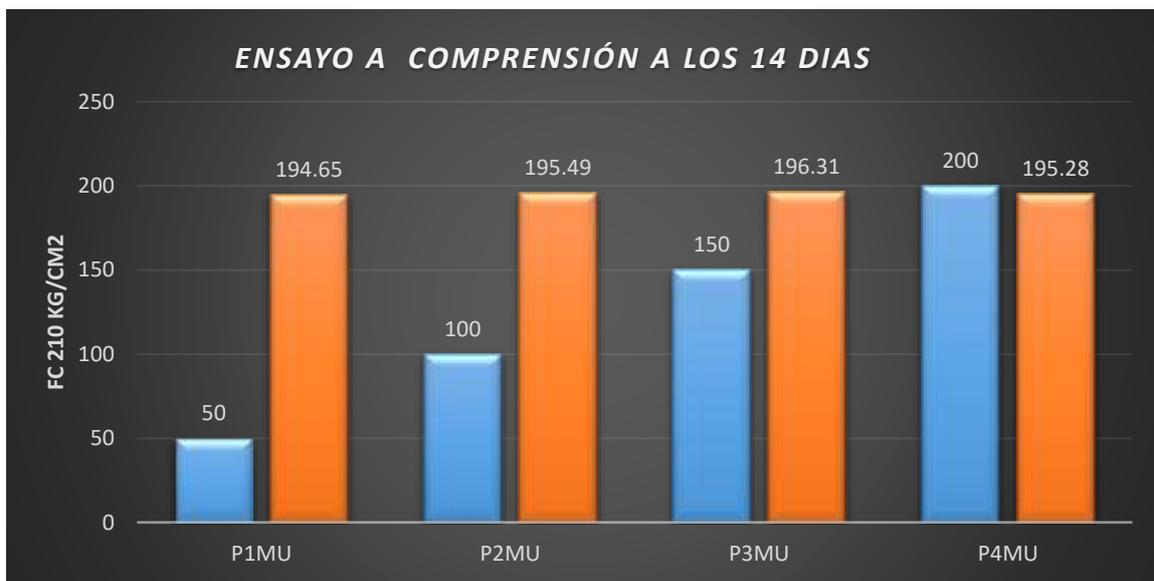
Figura 11. Resistencia a compresión de los 14 días
