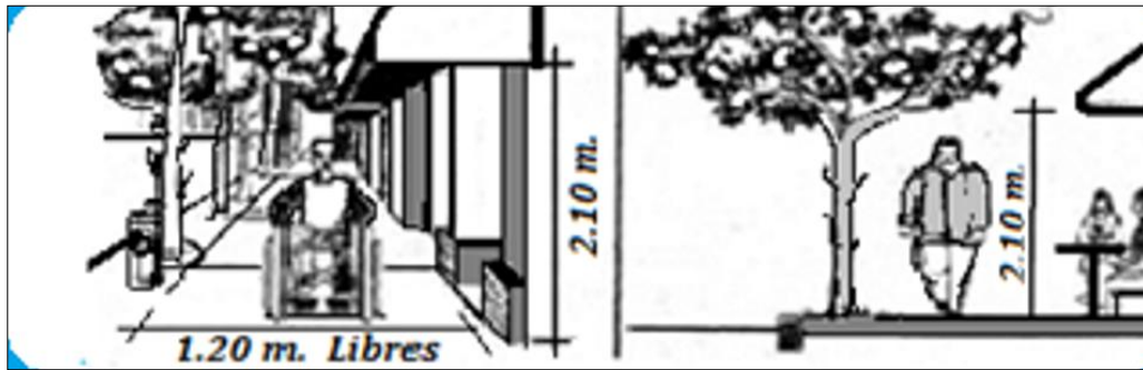
Figura 5. Medidas en los accesos para el libre tránsito de personas con discapacidad La imagen muestra las medidas mínimas para la libre transitividad en recorridos externos.
