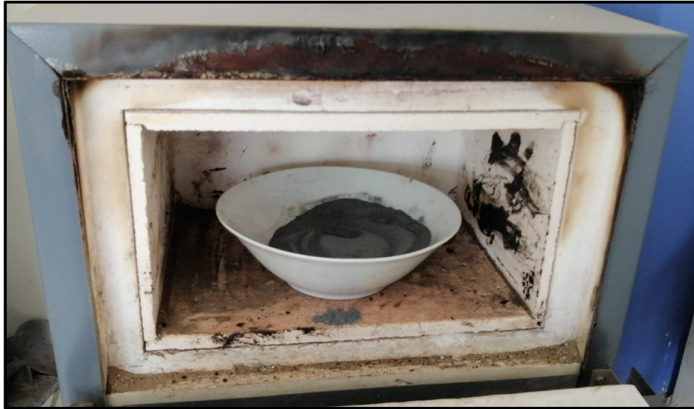
Figura 13 Calcinación de cascarillas de arroz de 430°C en 45 minutos.
