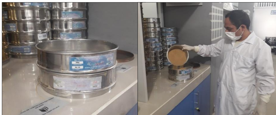
Figura N° 06: Tamizado de la Moena en el tamiz N° 60.
