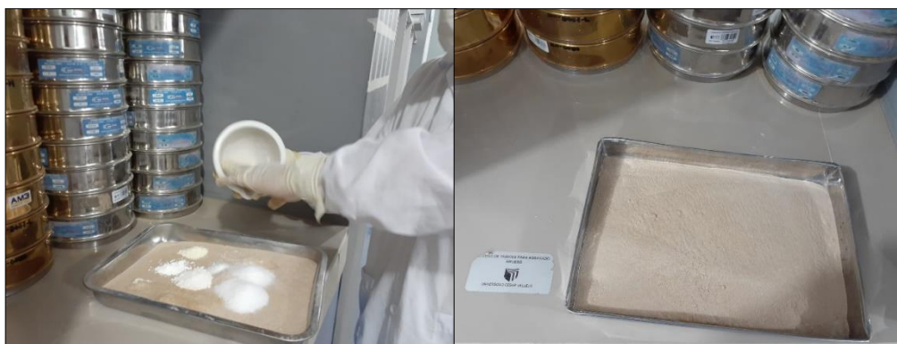
Figura N° 09: Cantidades específicas de los insumos químicos y homogenización con el tamizado de la Moena.
