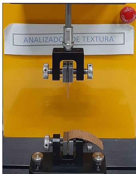
Figura N° 23: Rotura de la probeta por ensayo de Tracción.
