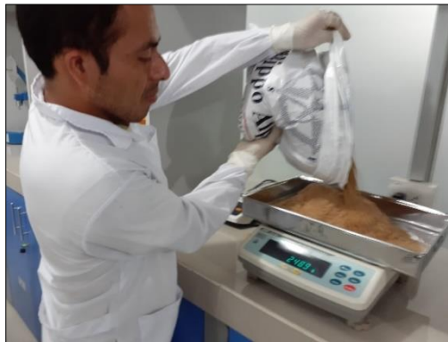
Figura N° 02: Pesado del pulverizado de Moena
