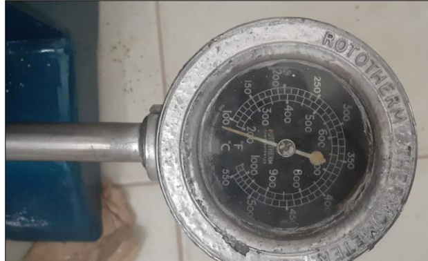
Figura N° 12: Pirómetro marcando los 100 °C .
