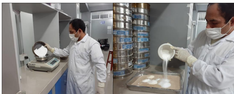
Figura N° 08: Pesaje de 70 gr de almidón de Yuca y otros insumos químicos como PEG, ZDMC, MBTS, Óxido de Zinc, Tiza, Acido esteárico, Tiza y Sílice.
