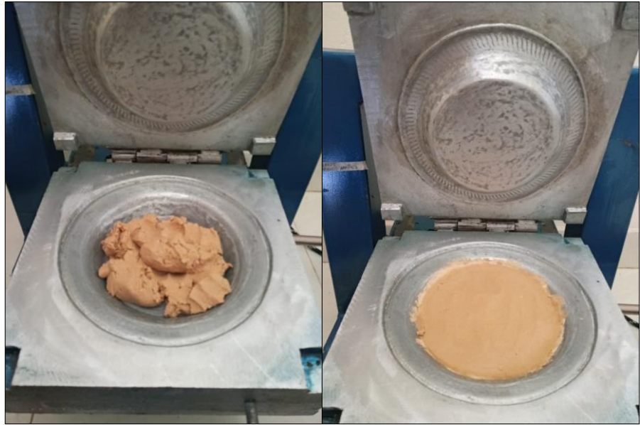
Figura N° 14: Ubicación de la masa en la cavidad del molde inferior.
