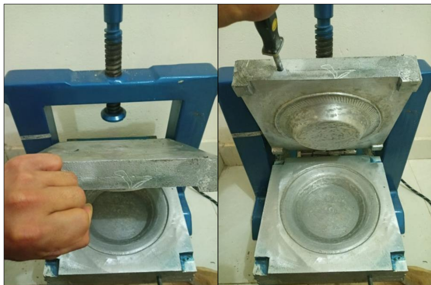
Figura N° 13: Levantamiento de del contramolde.
