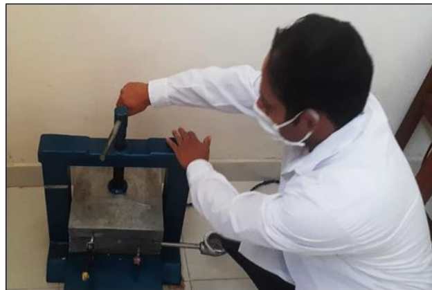
Figura N° 15: Ajuste de la prensa manual sobre la matriz.
