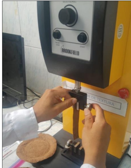
Figura N° 25: Ubicación de la probeta para ensayo de Flexión.
