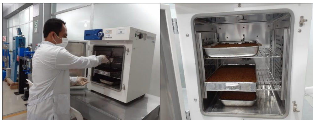
Figura N° 05: Secado del Pulverizado de Moena en la estufa a 100 °C por 36 horas.
