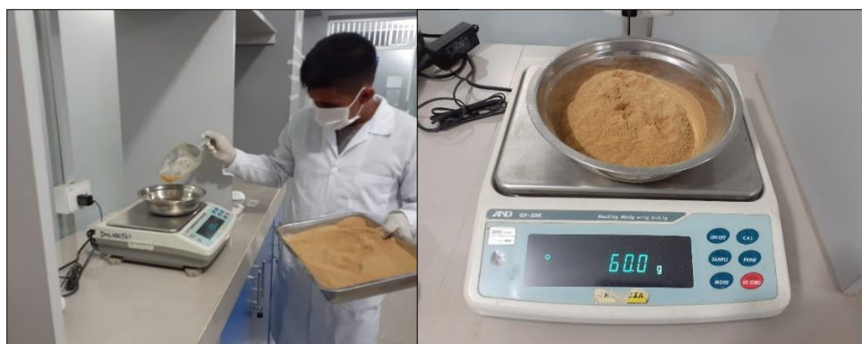
Figura N° 07: Pesaje de 60 gr. del Pulverizado de la Moena.
