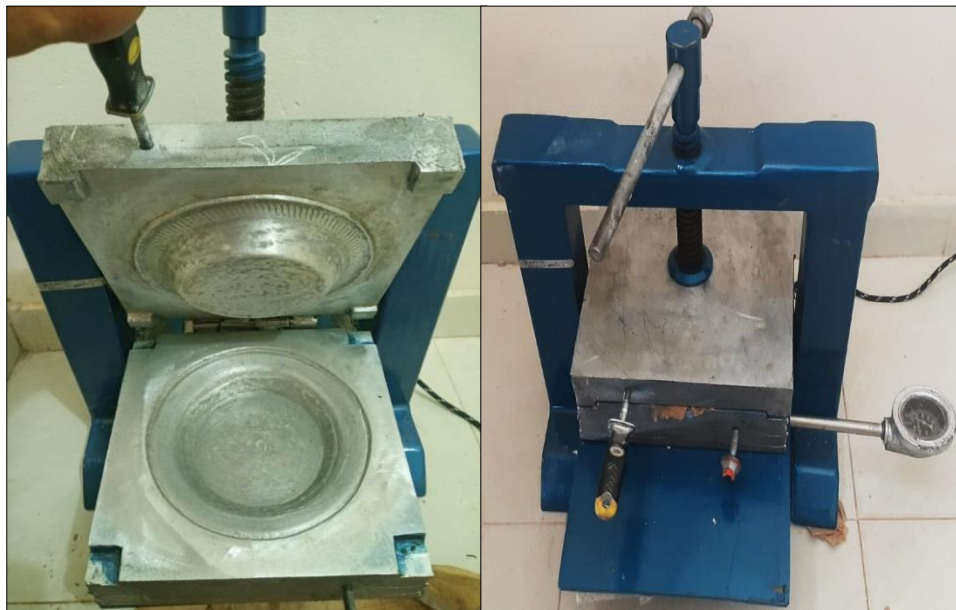
Figura N° 17: Matriz construida a prensa manual.
