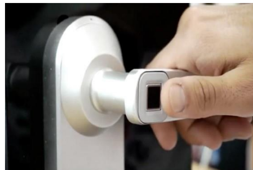
Figura 35: Cerradura Smart Una cerradura inteligente que se abre con la huella digital.
