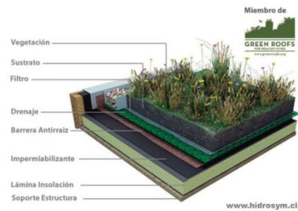
Figura 31: Sistema multicapa para la fabricación de techos verdes.
