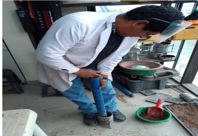
Figura N° 18: Maxima densidad seca
