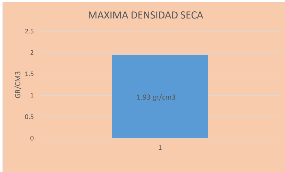
Figura N° 19. Máxima Densidad Seca de la muestra inicial.
