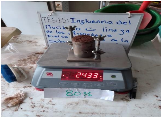
Figura N° 21: Maxima densidad seca Fuente: Elaboración propia.
