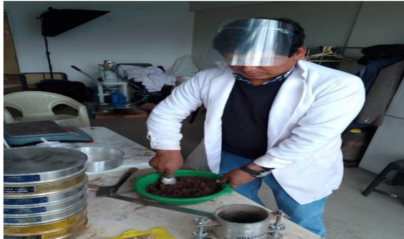
Figura 16: Optimo contenido de humedad Fuente: Elaboración propia
