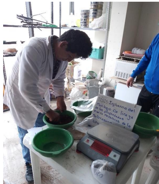
Figura N° 26: Optimo contenido de humedad
