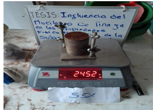
Figura N° 22: Maxima densidad seca Fuente: Elaboración propia.
