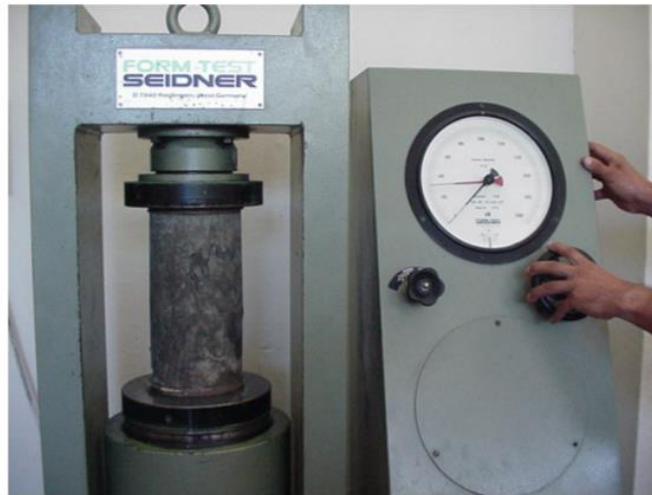
Figura 3: Ensayo de resistencia a la compresión del concreto
