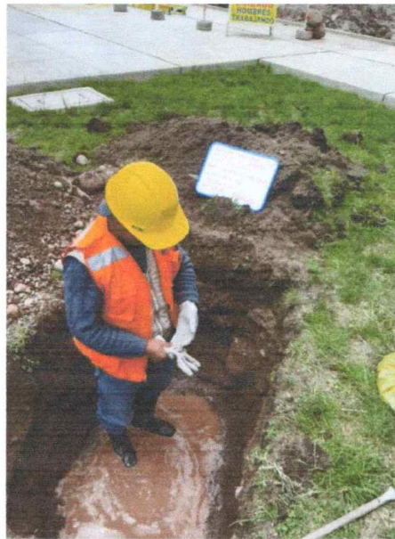
FOTO N°4: DETALLE DE ESTRATOS Y NAPA FREATICA PRESENTE EN CALICATA 02
