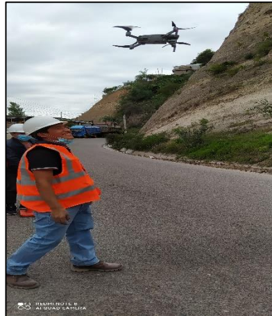
Figura 7. Ubicación de puntos de control y aplicación de altura de vuelo a 30m
