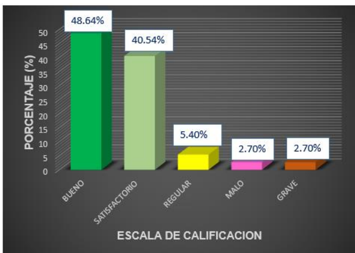
Figura 17. Clasificación de pavimento por empleo de dron a 30 m de vuelo
