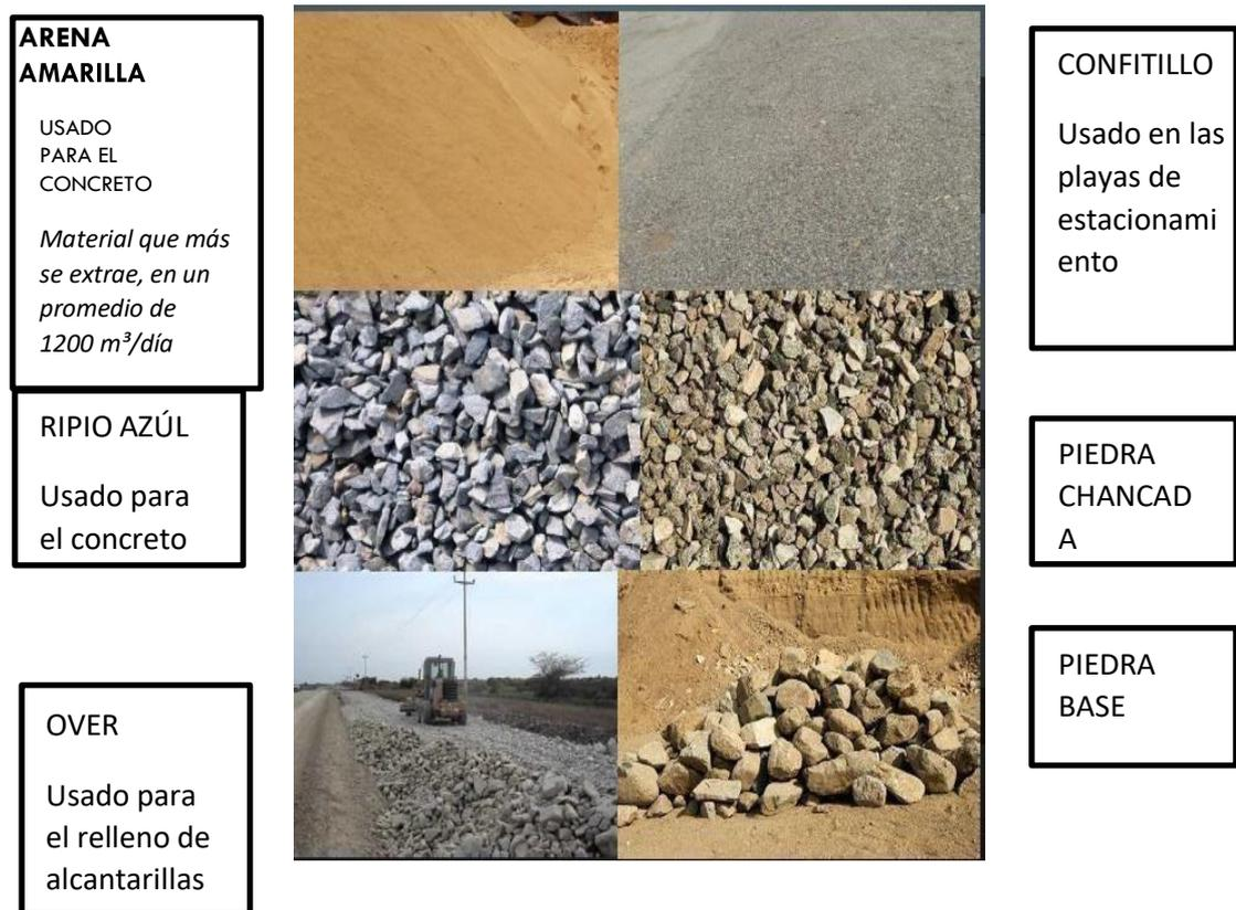
Figura 7. Agregados de la cantera
