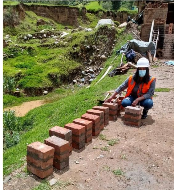
Fotos N° 05: Preparación de las pilas de ladrillo para el ensayo de resistencia a compresión axial de pilas.
