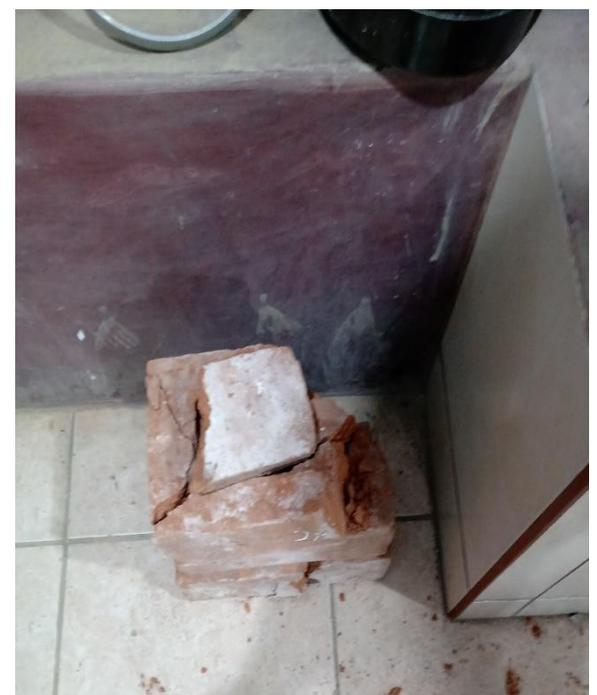
Fotos N° 06: Ensayo a resistencia a la compresión.
