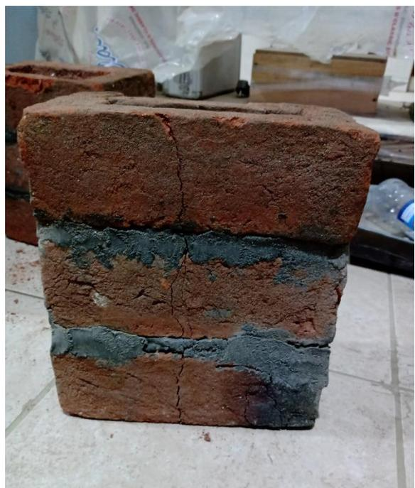
Fotos N° 08: Ensayo de resistencia a la compresión axial de pilas.
