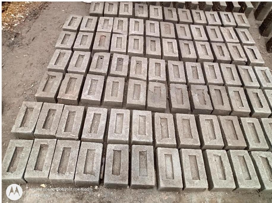
Foto N° 04: Secado de los ladrillos en el tendal.
