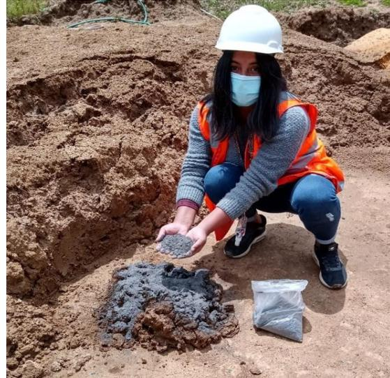
*Figura N° 06: Adición de la CPT a la masa de arcilla.*
