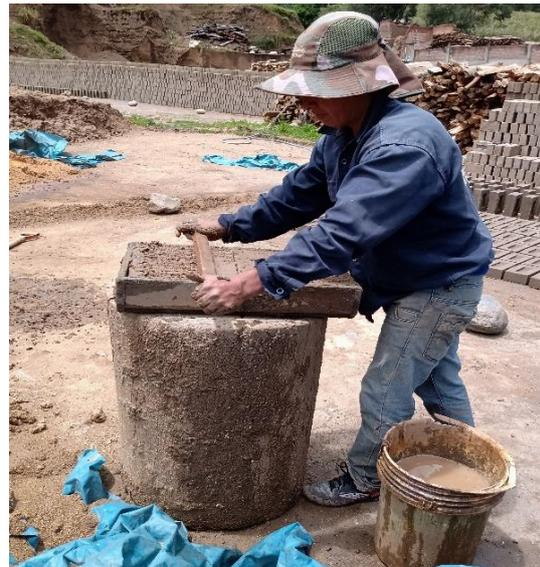
*Figura N° 08: Moldeado de los ladrillos.*
