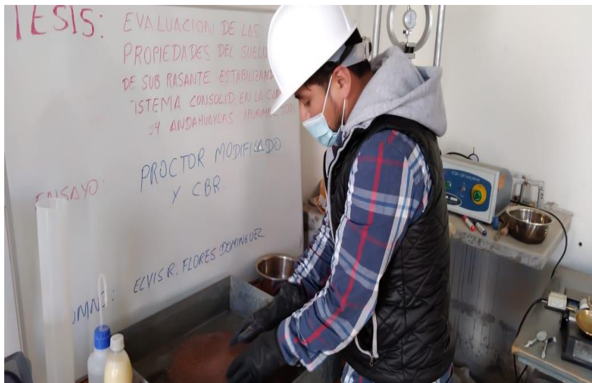
Fotografía 13. Adicionado el aditivo Solidry y Consolid según los % de dosificación
