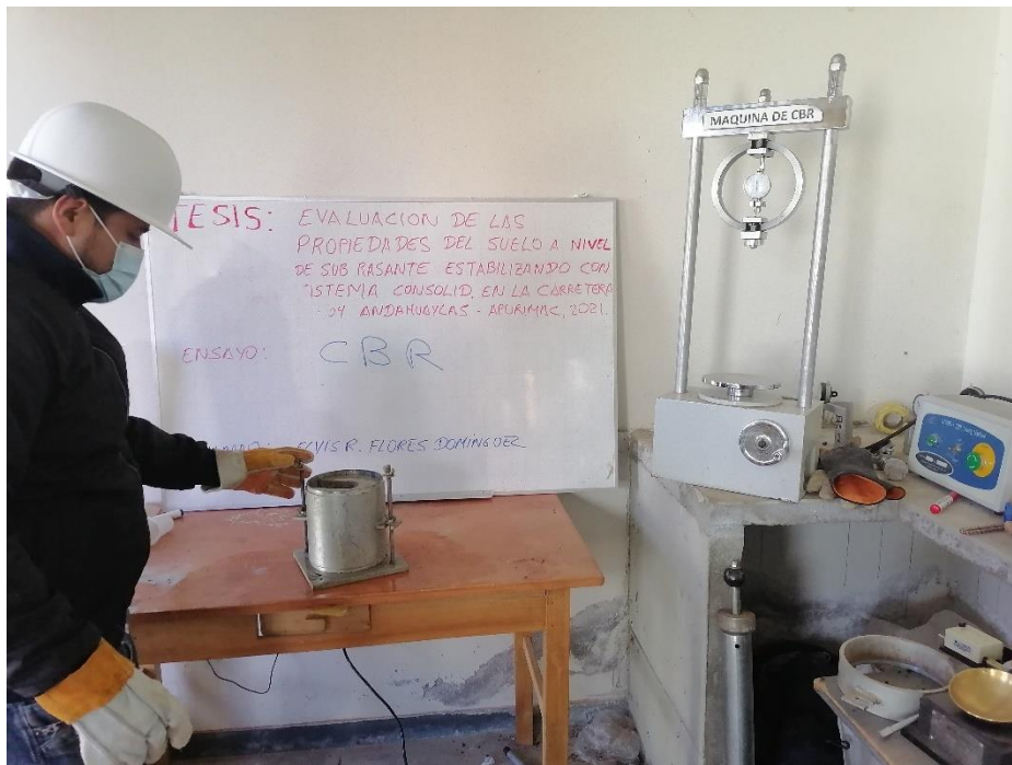
Fotografía 15. ensayo de CBR
