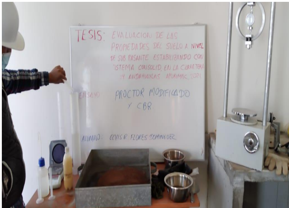
Fotografía 11. Midiendo aditivo consolid para añadir Al ensayo de proctor modificado
