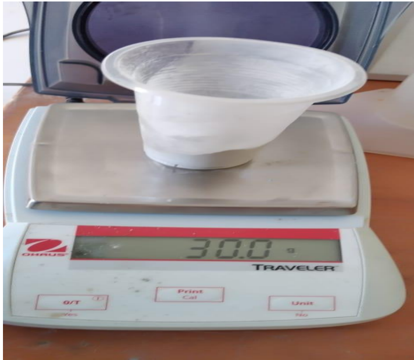
Fotografía 12. Pesando el aditivo Solidry según los % de dosificación
