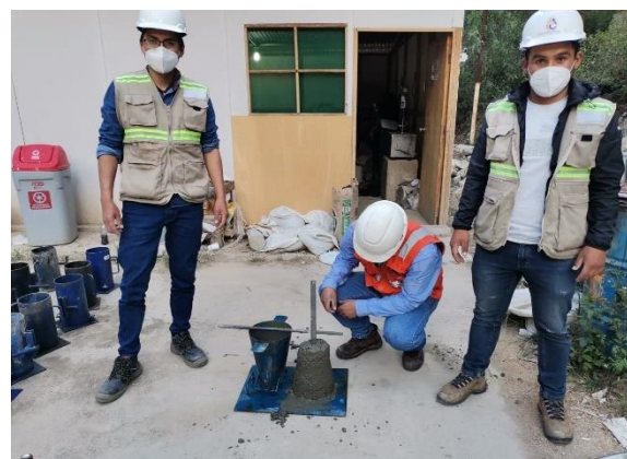
Ensayo de Asentamiento del Concreto Patrón
