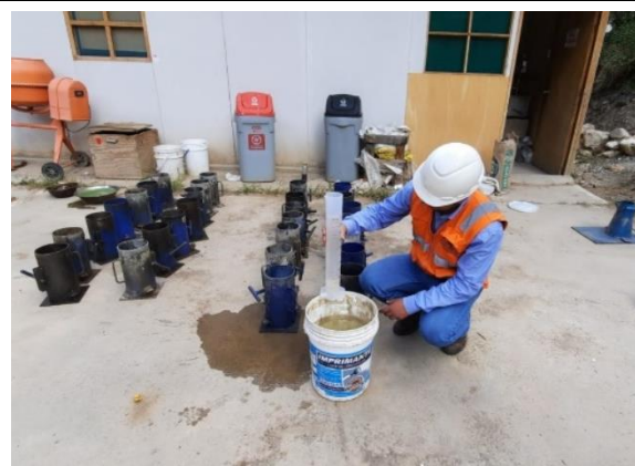
Preparación del Concreto - Dosificación del Agua
