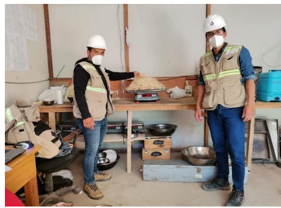
Preparación del Concreto - Adición de Fibra de Agave Amarillo
