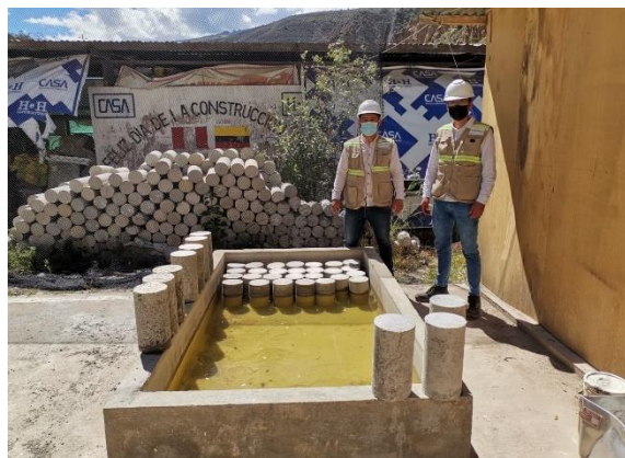
Extracción de las briquetas de concreto antes de realizar los ensayos mecánicos
