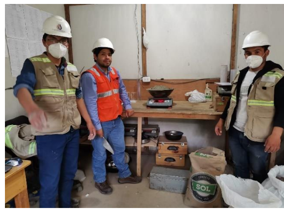
Preparación del Concreto – Peso por tanda de los Agregados
