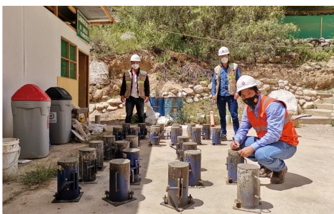
Figura N°07: Realización de Probetas de concreto.
