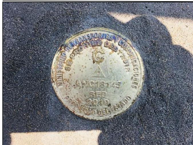
Figura 10 Hito de Punto de Control Geodésico ANC18145
