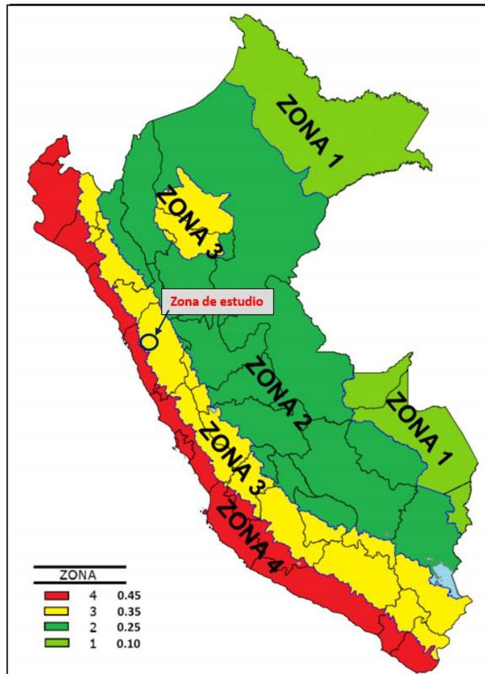
Figura 29 Zonificación sísmica del Perú
