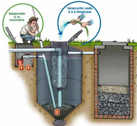
Figura 03: proceso de extracción de lodos y mantenimiento del biodigestor
