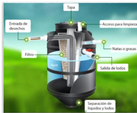
FIGURA 02: componentes y partes del biodigestor
