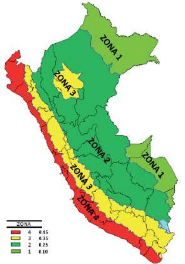
Figura 3. Mapa de Zonificación Sísmica del Perú, Según el Reglamento Nacional de Edificaciones o Norma Técnica de Edificación E.030 Diseño Sismorresistente.
