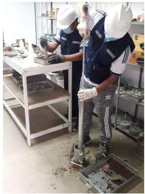
Figura 40: Proctor modificado con adición de NaCl.
