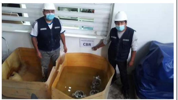
*Figura 44:* Especímenes de suelo con adición de cloruro de sodio sumergidos.
