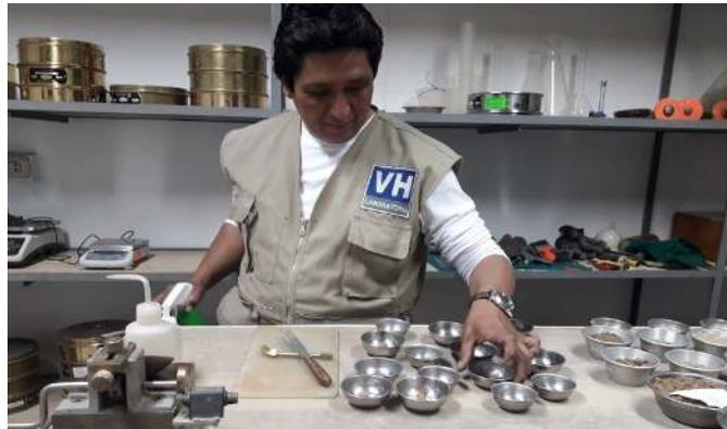
Figura 38: Límites de Atterberg con adición de NaCl
