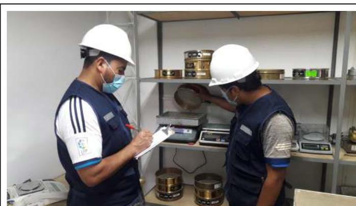
*Figura 24: Pesado de material retenido en cada tamiz.*
