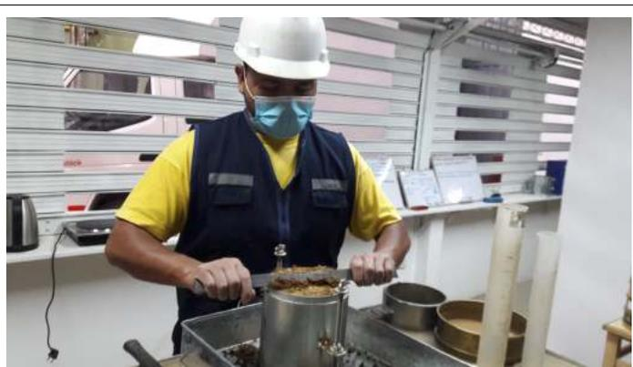
*Figura 42: enrasado de especímenes se suelo con adición de cloruro de sodio.*
