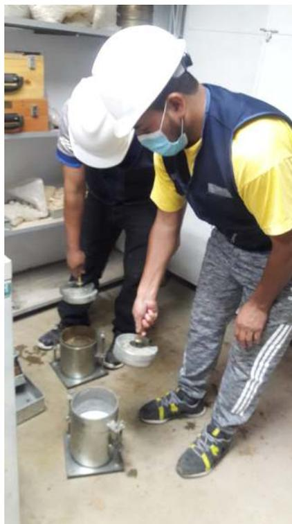
*Figura 43: Colocación de sobrepesos en especímenes de suelo con adición de cloruro de sodio.*
