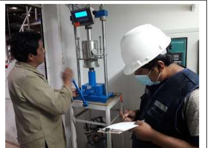
*Figura 46:* Penetración de especímenes de suelo con adición de cloruro de sodio.
