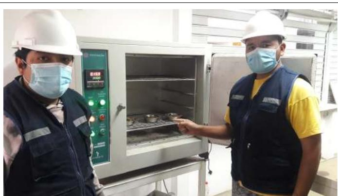
*Figura 21: Toma de muestra para contenido humedad.*
