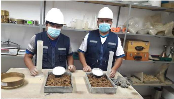
Figura 39: Adición de cloruro de sodio a suelo patrón.
