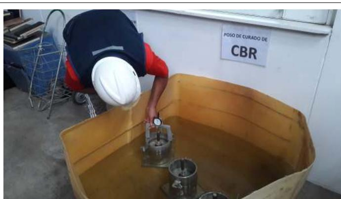
Figura 34: Verificación de expansión de especímenes
