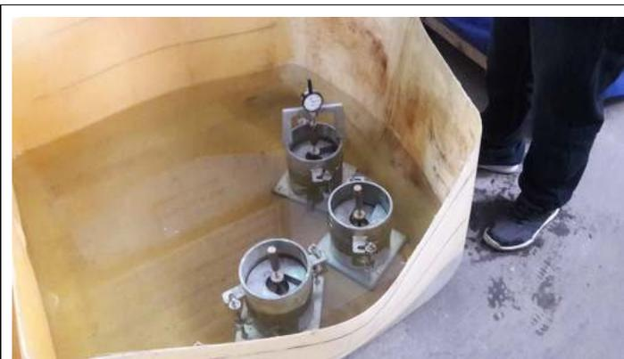
Figura 33: Especímenes de suelo patrón sumergidos.
