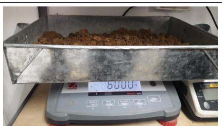
Figura 29: Preparación de muestra representativa para C.B.R. para suelo patrón.
