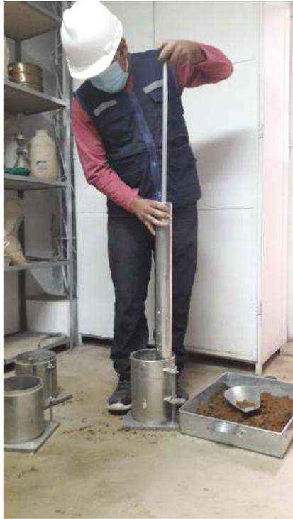
*Figura 30: Compactación de muestra en moldes C.B.R.*
