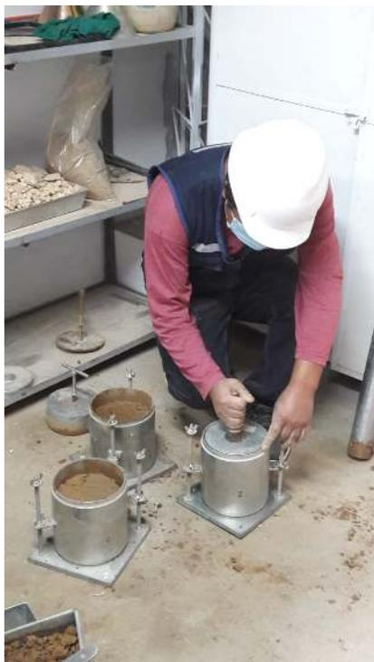
*Figura 32: Colocación de sobrepeso en los especímenes de suelo patrón para C.B.R.*
