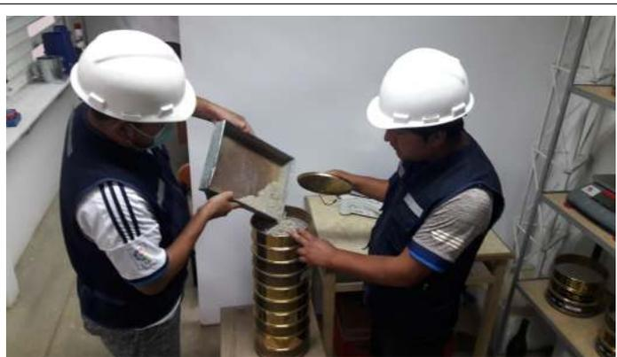
*Figura 23: Tamizado de la muestra de suelo*
