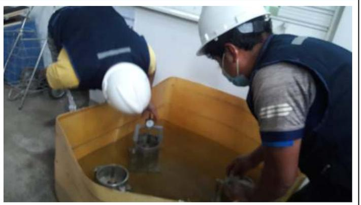
*Figura 45:* Verificación de expansión de especímenes de suelo con adición de cloruro de sodio.
