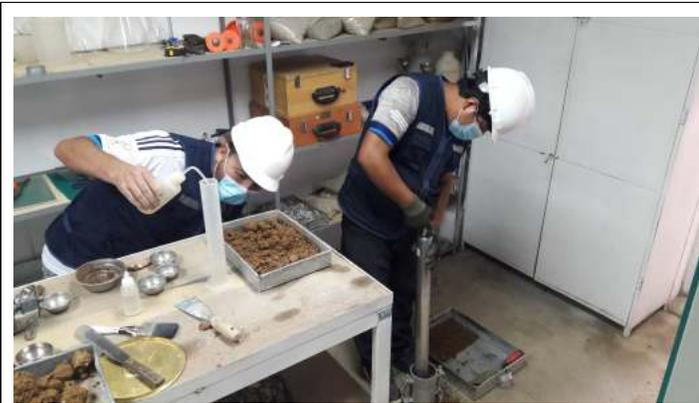
Figura 28: Proctor modificado – método B.
