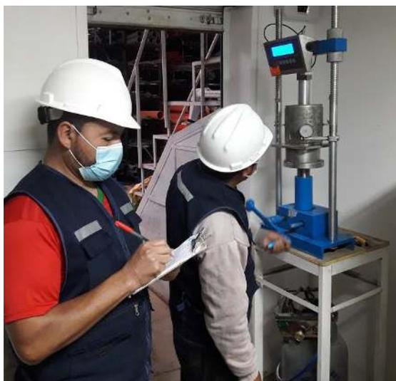
Figura 35: Ensayo de penetración a suelo patrón.
