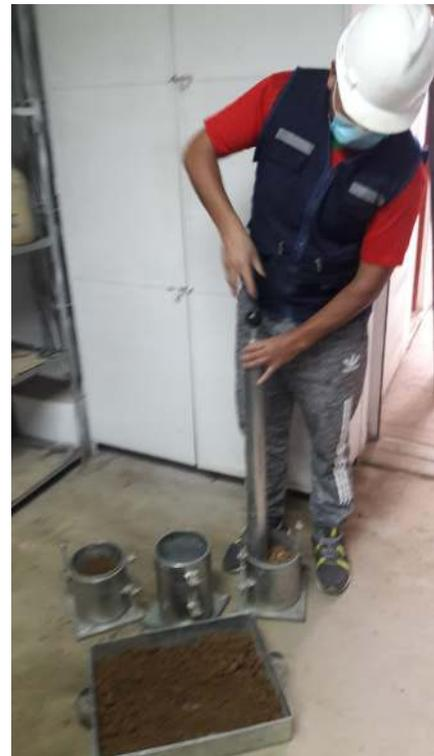
Figura 41: Compactación para C.B.R – muestras con adición de cloruro de sodio.
