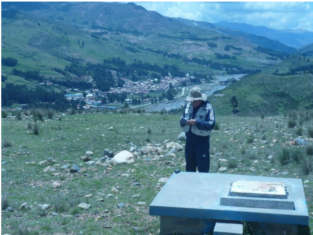
FOTOGRAFÍA N°13: CRP6-04 se midió el caudal encontrándose un caudal de 6lt/S
