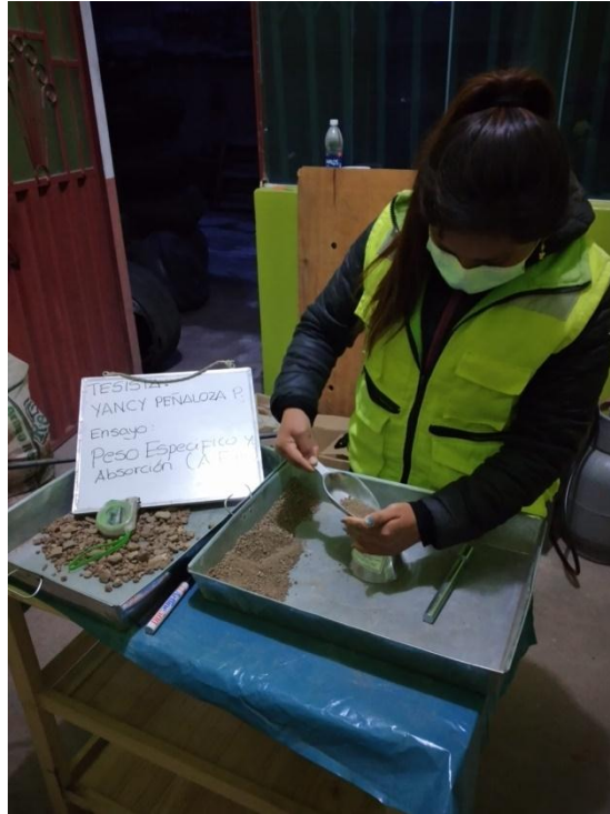
Fotografía N°7 : Se visualiza realizando el peso especifico
