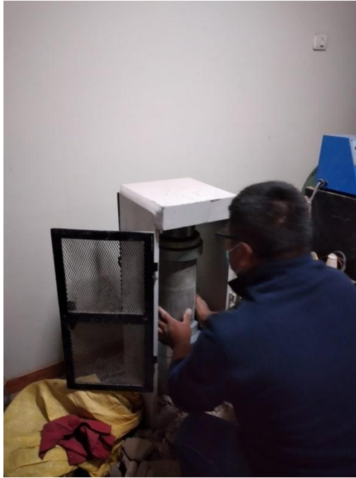
Fotografía N°10 : Se visualiza colocando la briqueta para poder realizar la prueba de rotura y así obtener la f_c .
