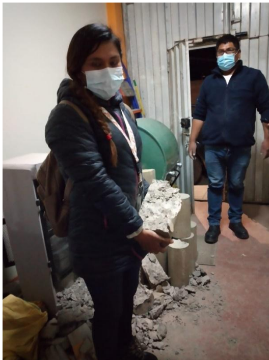
Fotografía N°11 : Se visualiza briqueta después de pasar la prueba de rotura.
