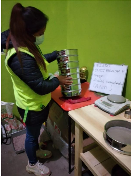
Fotografía N°3 : Se visualiza realizando el análisis de granulometría agregado fino
