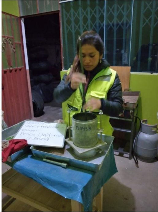
Fotografía N°5 : Se visualiza realizando el peso unitario del agregado grueso
