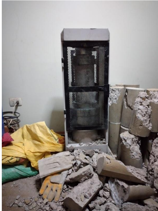
Fotografía N°12 : Se visualiza briqueta después de pasar la prueba de rotura.
