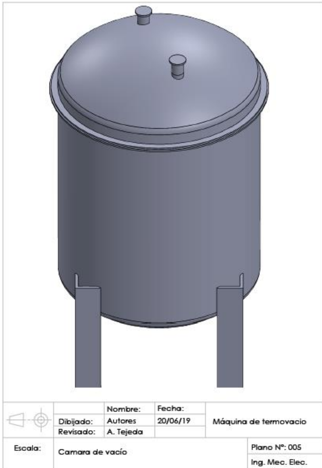
Figura 20: Representación CAD del cámara de vacío.
