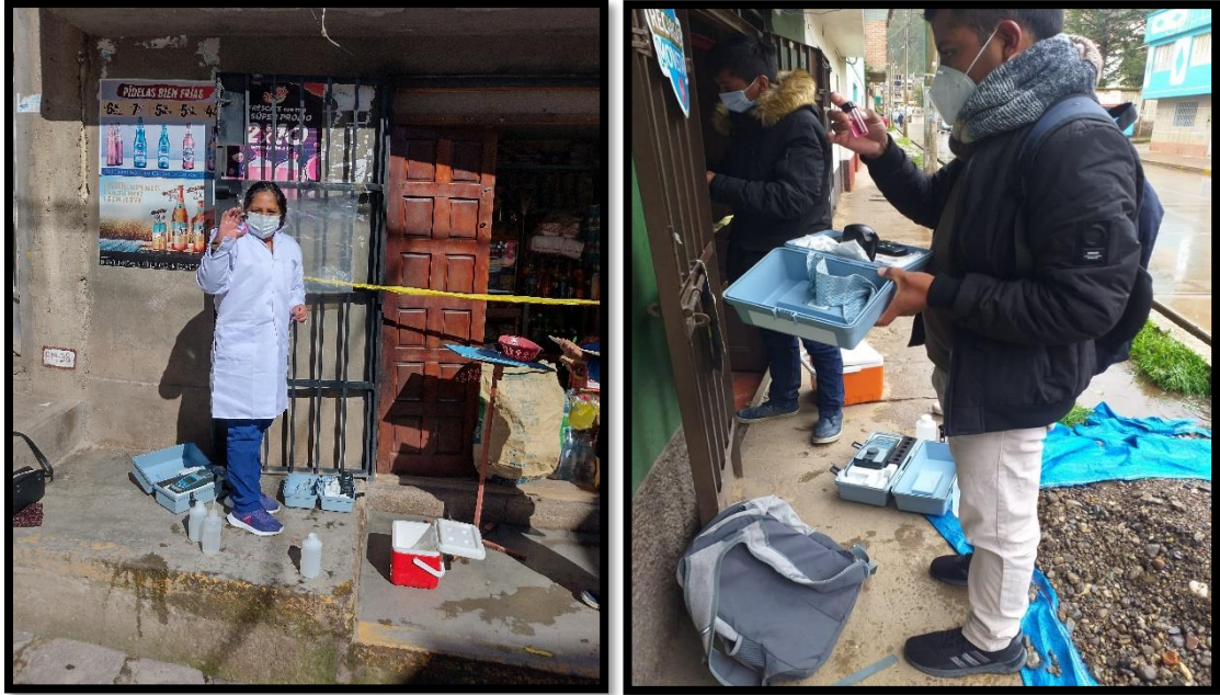
Figura 28. Uso de 1.5 mg de (DPD) para medir el cloro residual libre.
