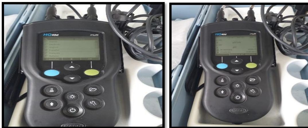
Figura 32. Encendido del multiparámetro para medir PH en las redes intradomiciliarias.
