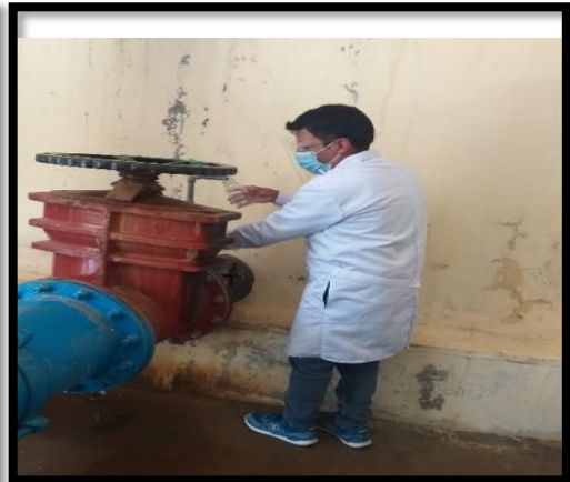
Figura 24. Calibración del colorímetro y toma de muestra.
