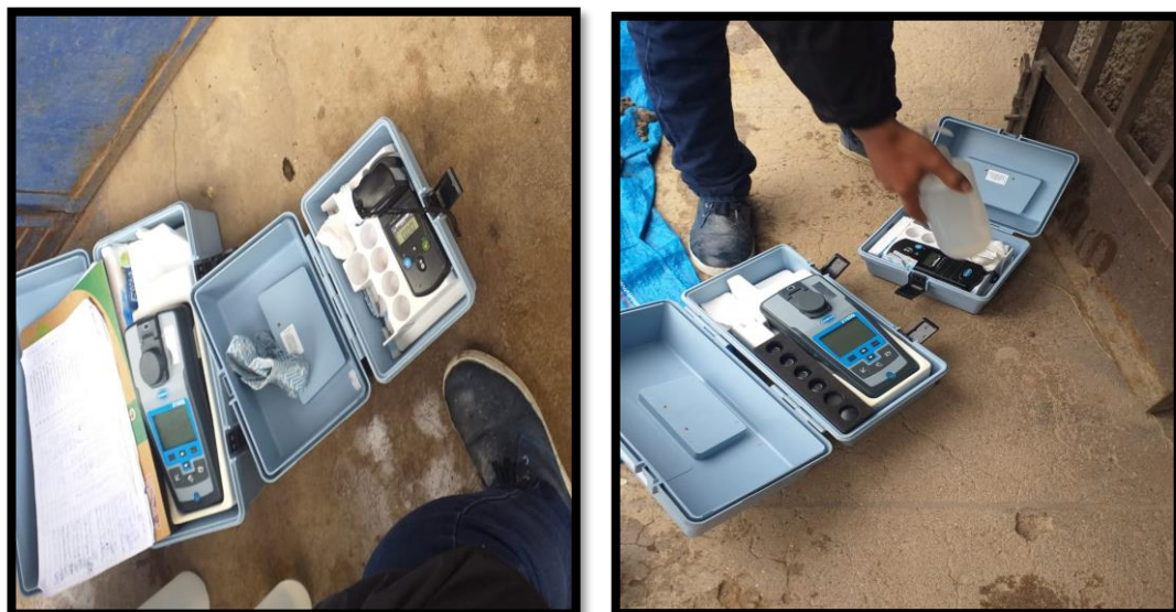
Figura 27. Calibración del colorímetro y toma de muestra en las redes intradomiciliarias.
