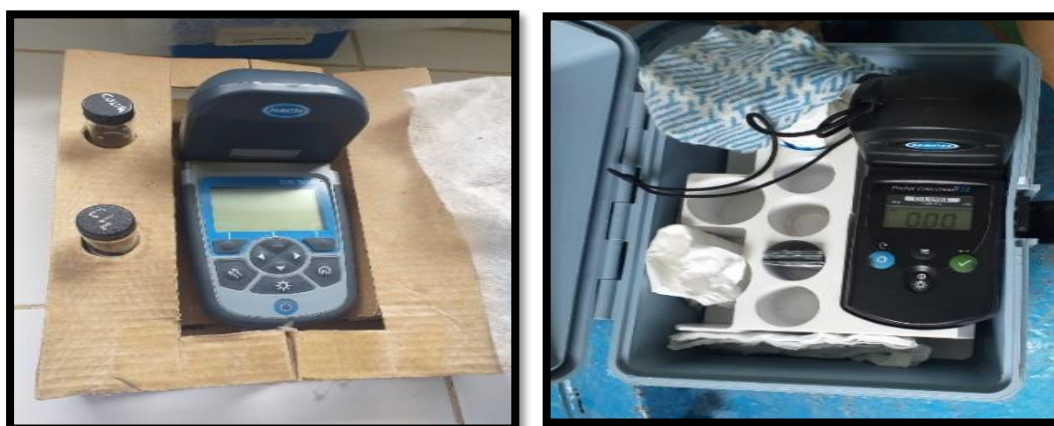
Figura 19. Calibración del colorímetro.
