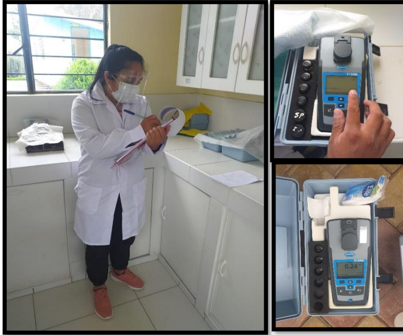
Figura 11. Lectura y registro de turbidez a la salida de la planta.
