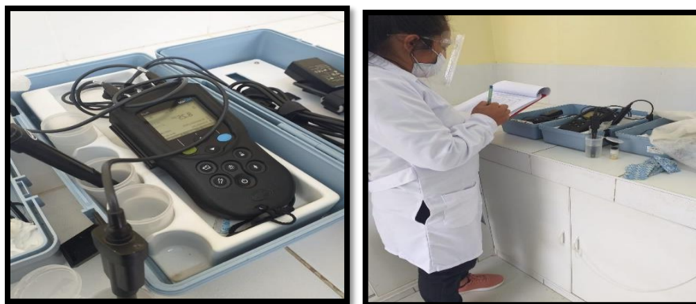
Figura 15. Lectura y registro del PH a la salida de la planta.
