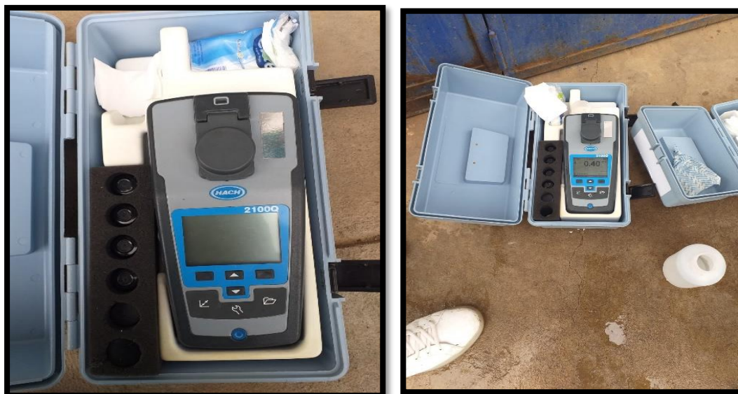
Figura 30. Encendido y calibración del turbidímetro.
