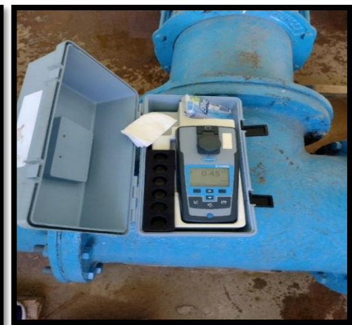
Figura 25. Uso de 1.5 mg (DPD) en el frasco con la muestra y lectura de cloro residual en el reservorio.
