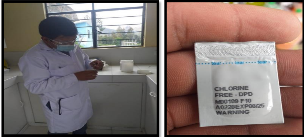
Figura 21. Uso de 1.5 mg (DPD) en el frasco con la muestra tomada.
