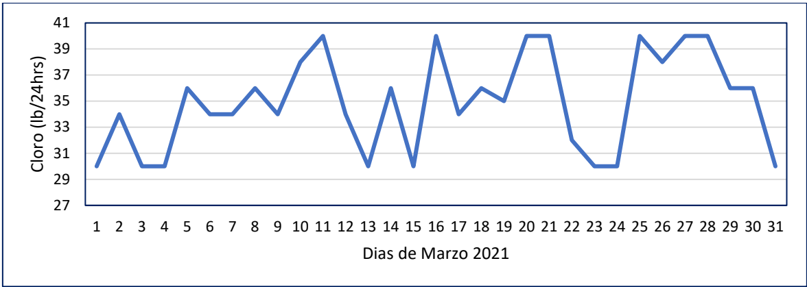
Figura 68. Comportamiento diario de la cloración del agua de la PTAP – MILLPO – marzo.
