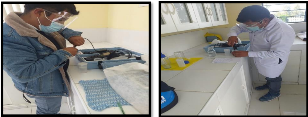
Figura 13. Enjuague del electrodo para eliminar el agua del electrodo.
