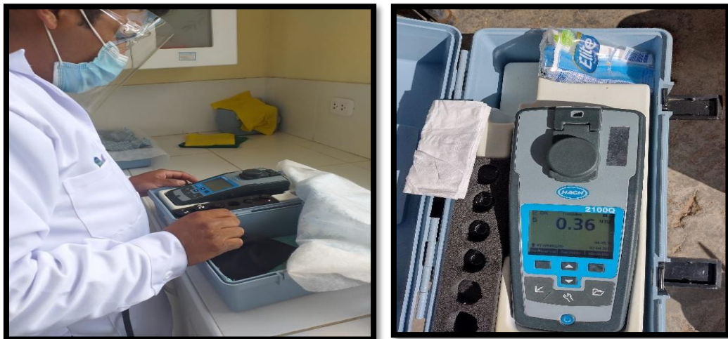
Figura 22. Lectura y registro de cloro residual a la salida de la planta.
