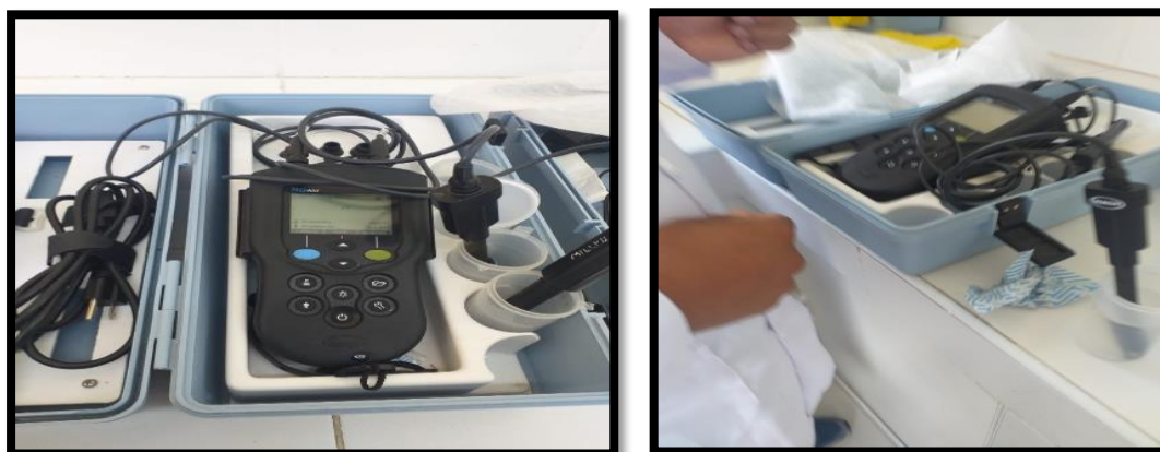
Figura 33. Introducción del electrodo en la muestra a medir.
