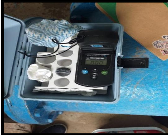
Figura 24. Calibración del colorímetro y toma de muestra.
