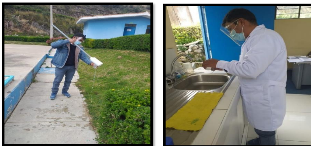
Figura 20. Toma de muestra para medición de cloro residual a la salida de la planta.
