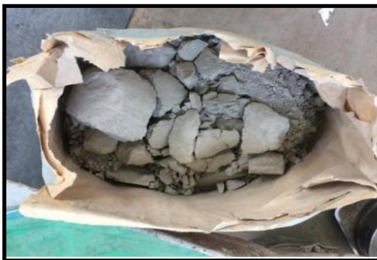
Figura 2: Bolsa de cemento con grumos
