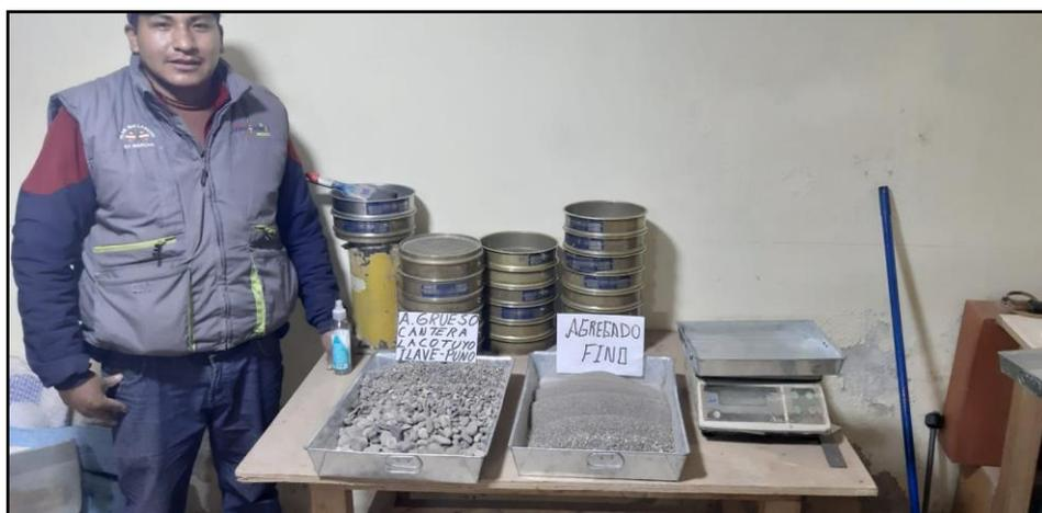
Figura 05, Granulometría del agregado grueso y fino.
