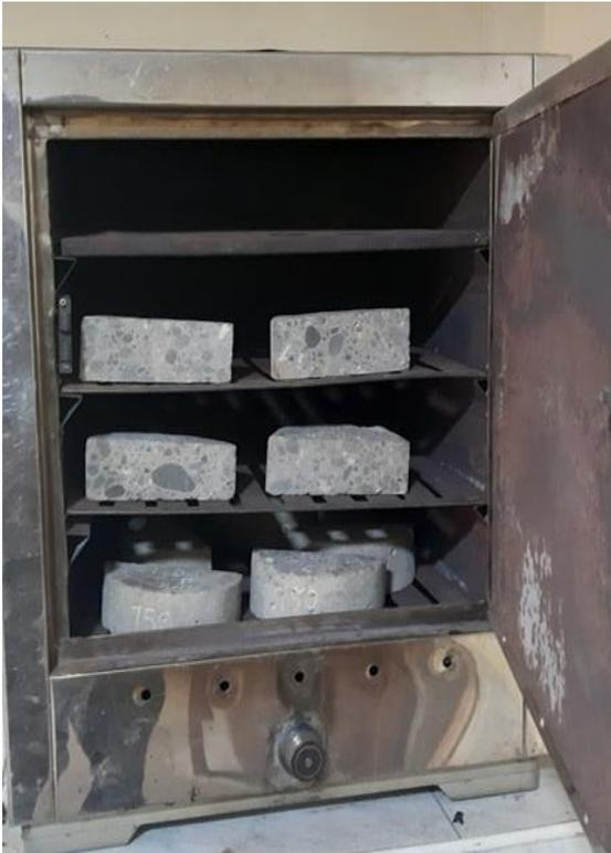
**Secado de la muestra en horno**
