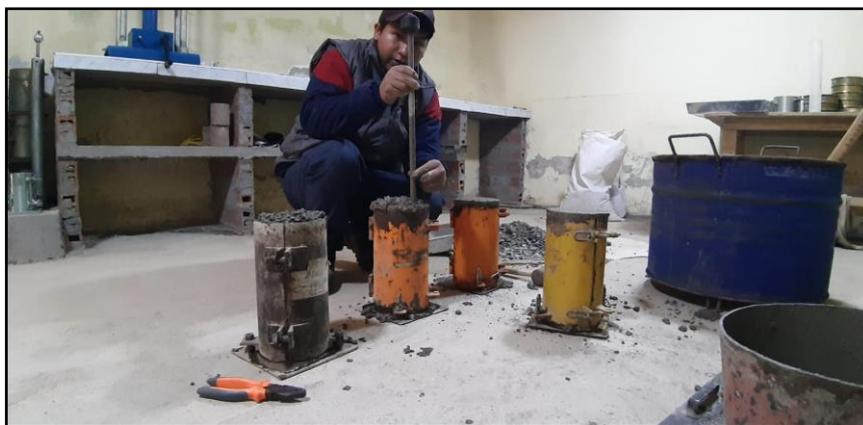
Figura 06, Elaboración de probetas cilíndricas de 6" x 12".
