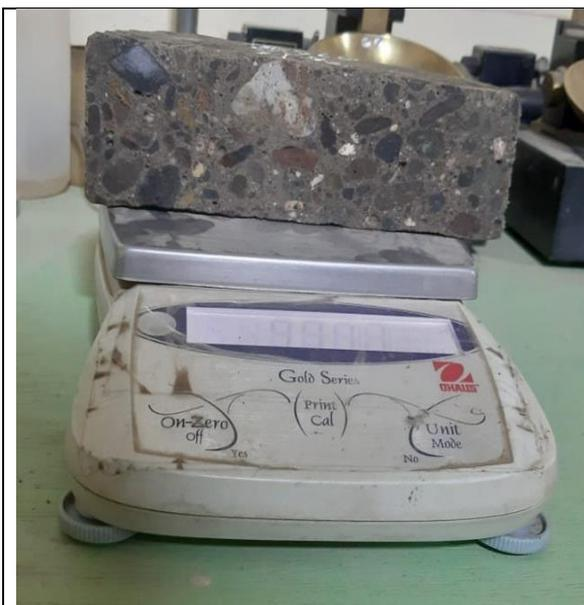
Figura 22: Peso de muestra Saturada Superficialmente seca.
