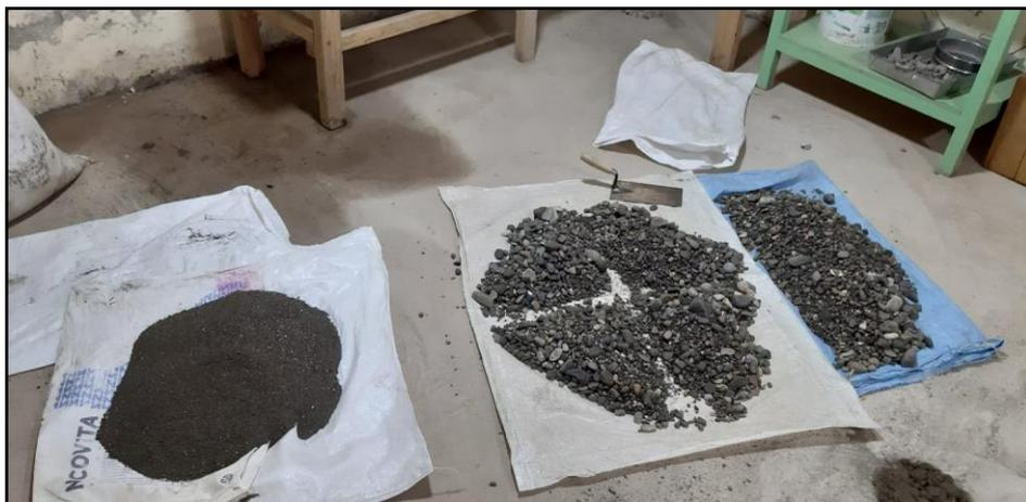
Figura 04, cuarteo del agregado grueso.
