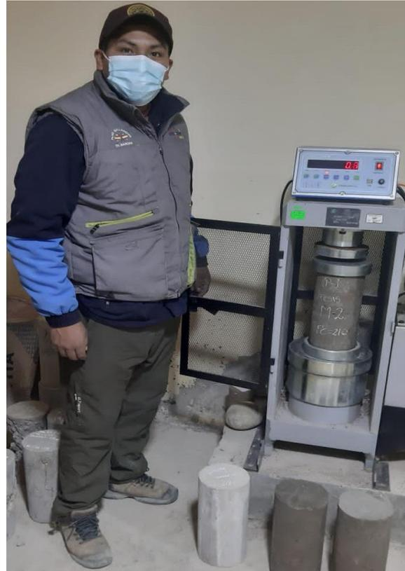
**Rotura de probetas**
