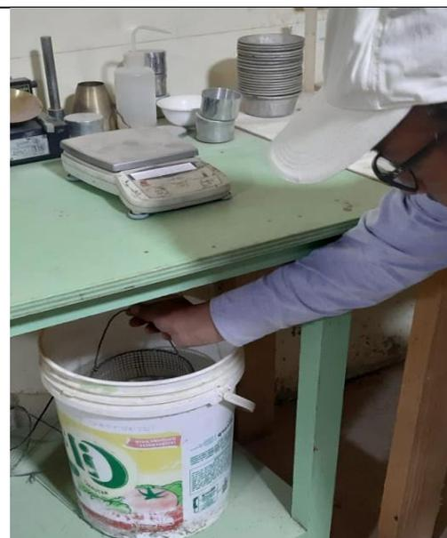
Figura 23: Peso Sumergido de la muestra.
