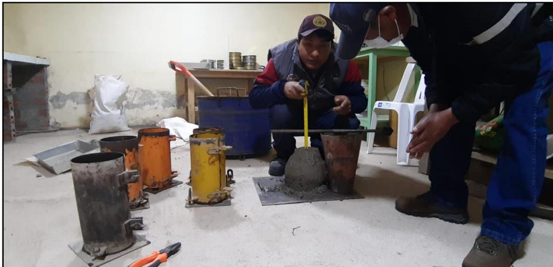
Figura 08, Ensayo de asentamiento (ASTM C143)
