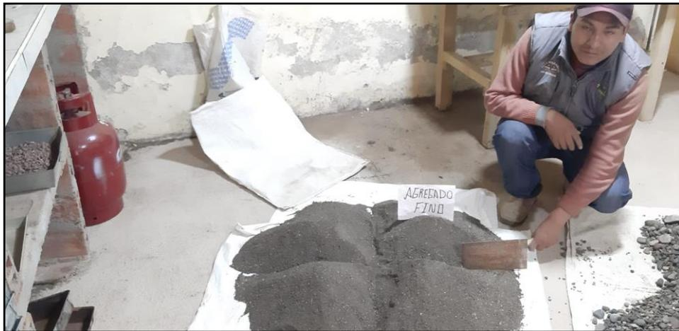
Figura 03, cuarteo del agregado fino.
