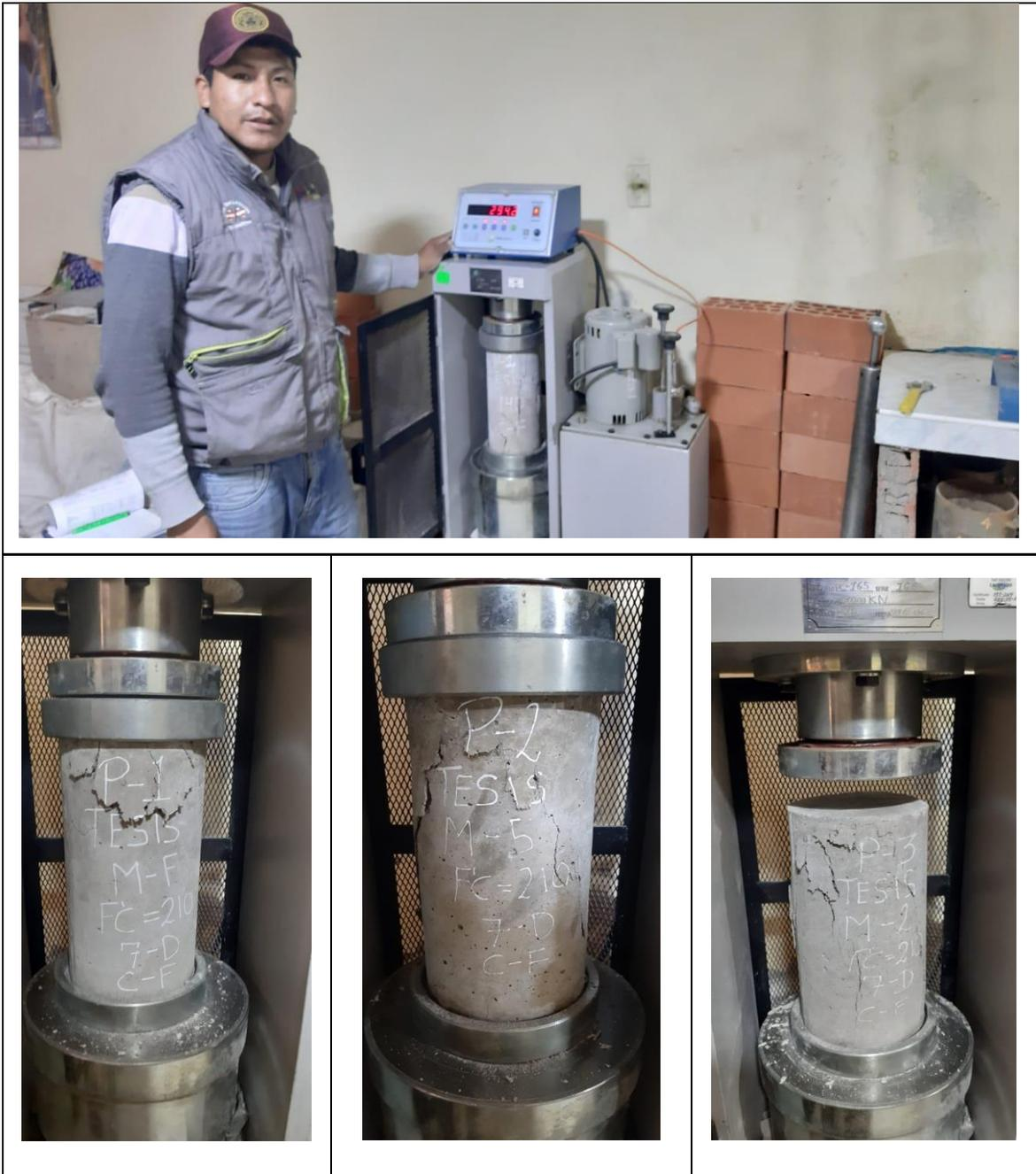
Figura 09, Ensayo de Resistencia a la Compresión
