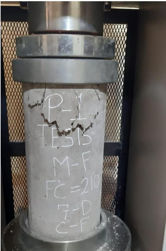
**Rotura de probeta M-F**
