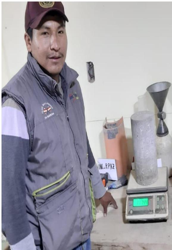
**Peso de la probeta almacenado**
