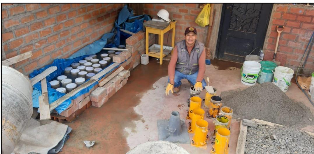
Figura 07, curado de las probetas.
