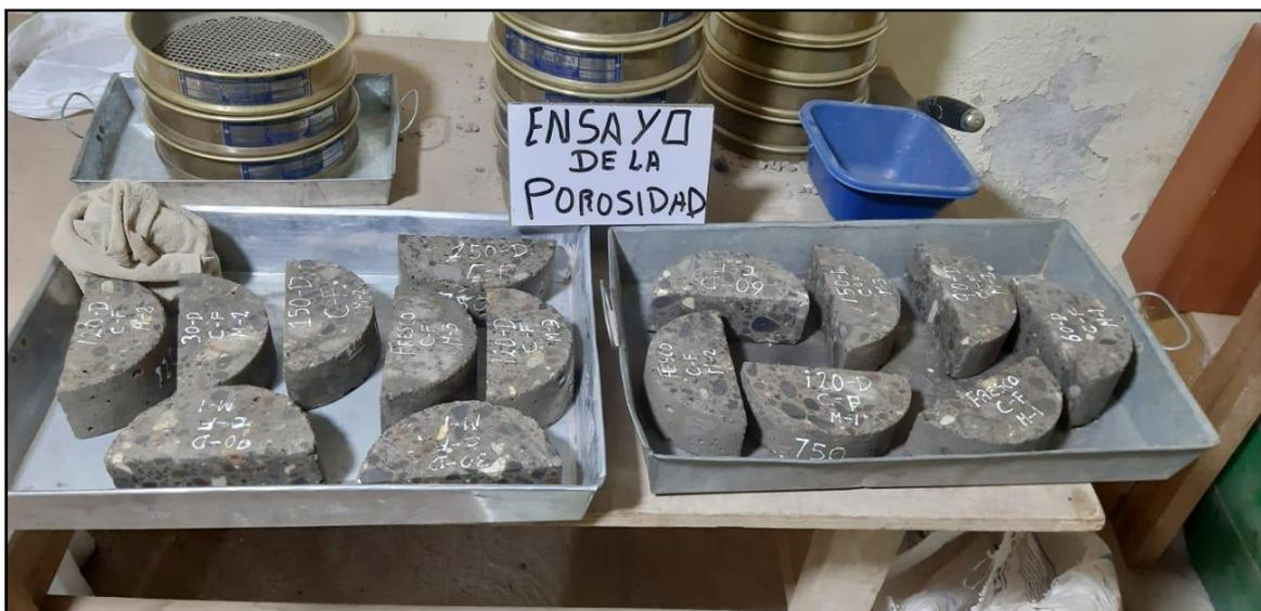
Figura 10, Ensayo de la porosidad
