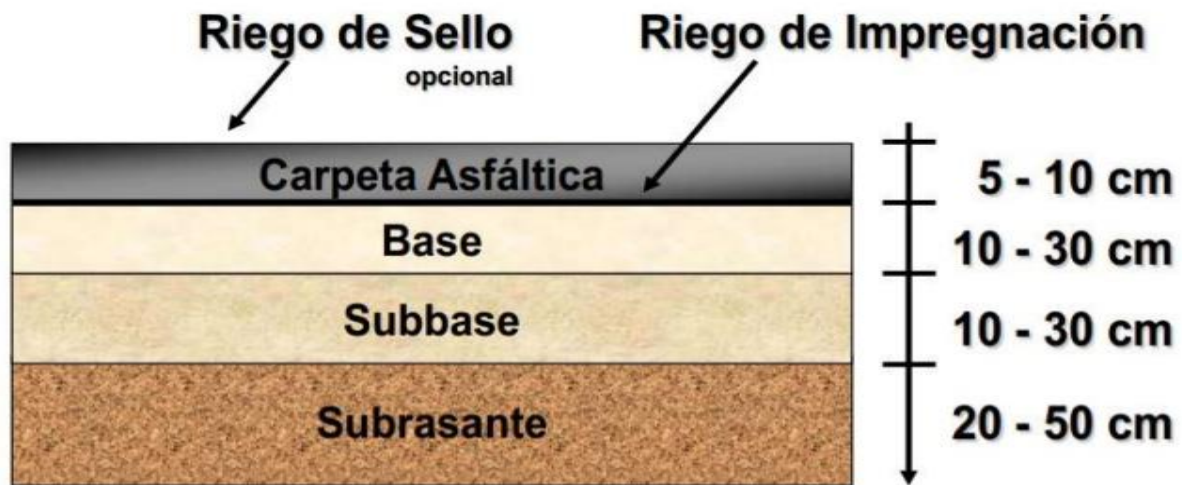
Figura 1. Esquema de capas del pavimento flexible
