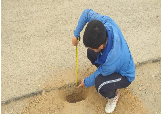
Espesores de la estructura
