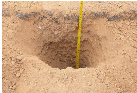
Excavación para evidenciar las capas
