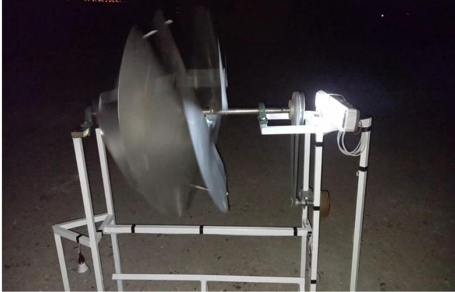
Figura 42. Prueba de aerogenerador en campo encendiendo luz de emergencia.
