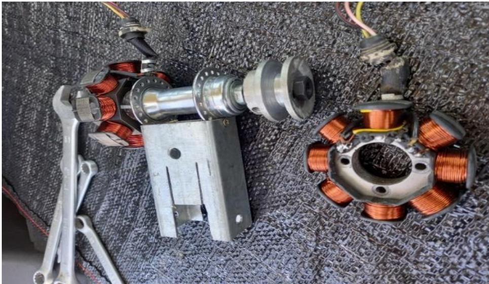
Figura 39. Estator reutilizado unido a un buje de bicicleta.
