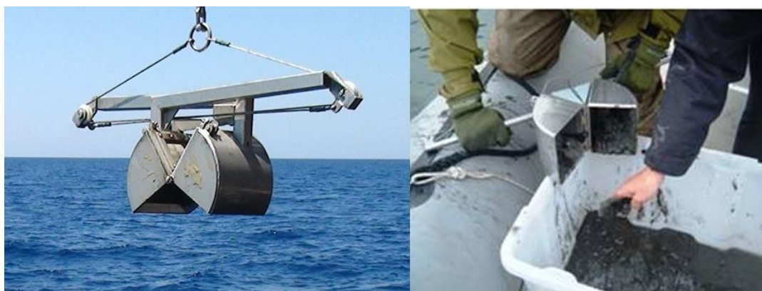
Figura 13. Draga Van Veen para colecta de sedimento a) antes de ser lanzado al mar. Fuente: https://www.q3eo.com/servicios.html y b) muestras con sedimento
