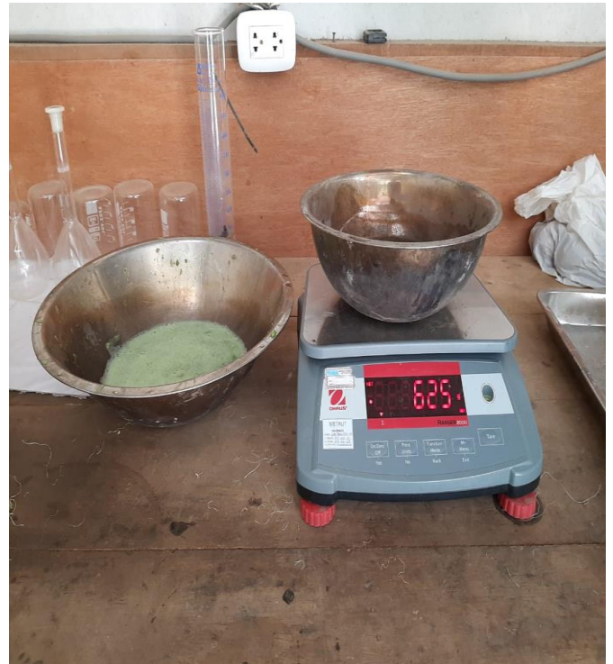
Fotografía. 2 Se muestra en la imagen el mucilago de penca de tuna y el superplastificante sika n290.
