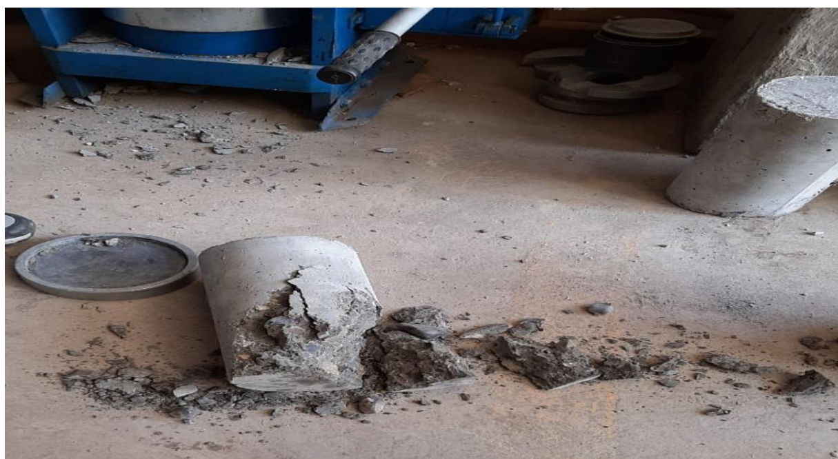
Fitografía. 6. Se muestra en la imagen la realización del ensayo de resistencia a la compresión de las muestras.
