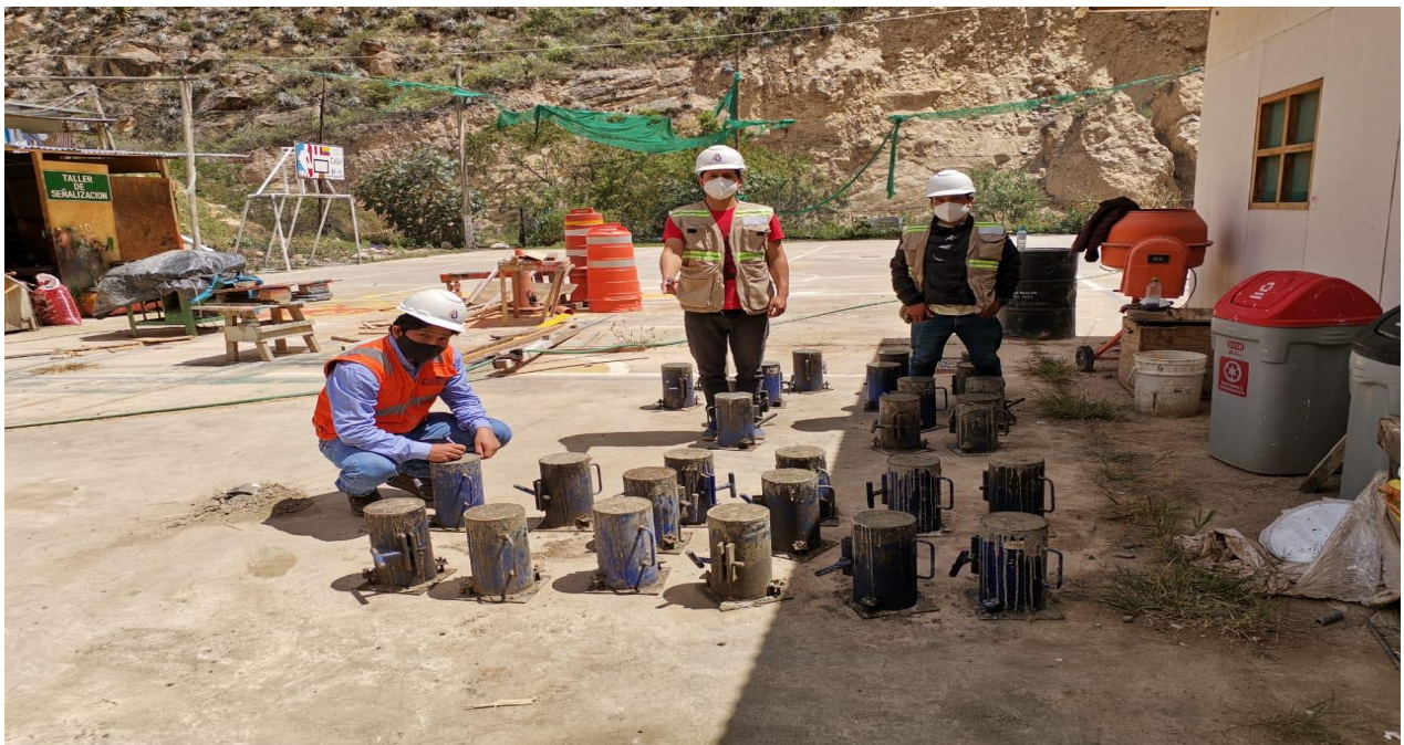
Fotografía. 4. Se muestra en la el ensayo de asentamiento del concreto con adición de mucilago de penca de tuna y superplastificante sika n 290.
