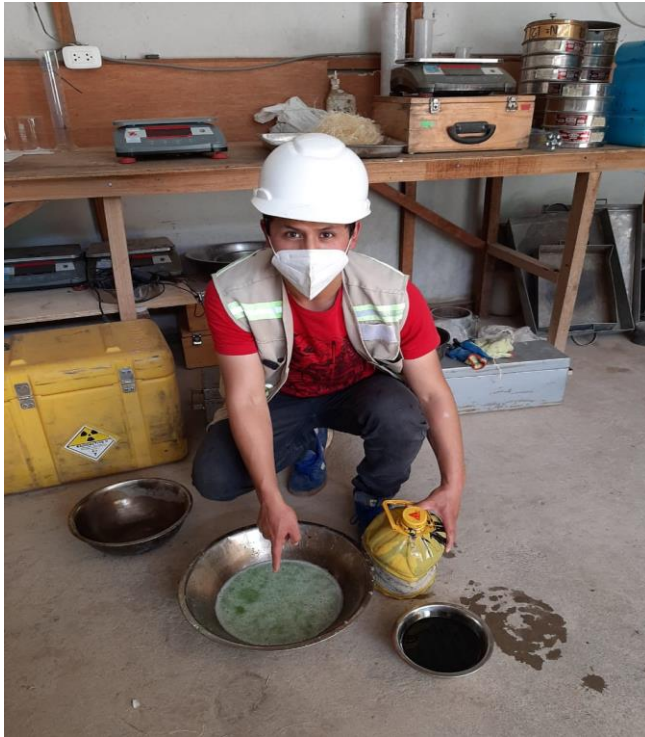
Fotografía. 2 Se muestra en la imagen el mucilago de penca de tuna y el superplastificante sika n290.
