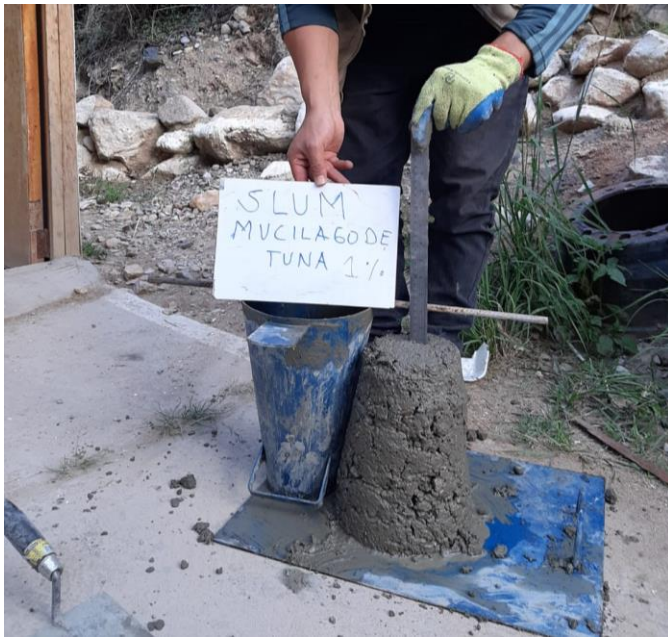
Fotografía. 4. Se muestra en la el ensayo de asentamiento del concreto con adición de mucilago de penca de tuna y superplastificante sika n 290.
