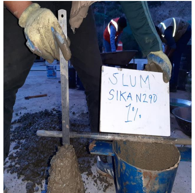
Fotografía. 4. Se muestra en la el ensayo de asentamiento del concreto con adición de mucilago de penca de tuna y superplastificante sika n 290.
