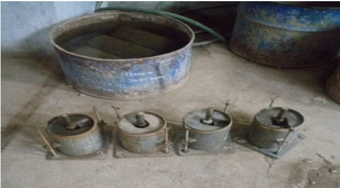
**Figura 35:** Se aprecian los moldes retirados del agua media hora antes del ensayo CBR.
