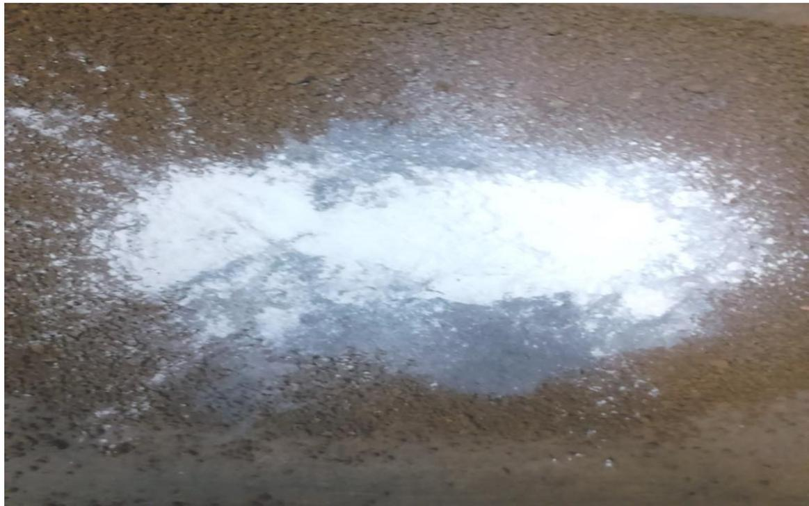
**Figura 31:** Combinación respectiva de la cal y ceniza de bagazo de caña de azúcar para los 2 ensayos de compactación de las muestras experimentales.
