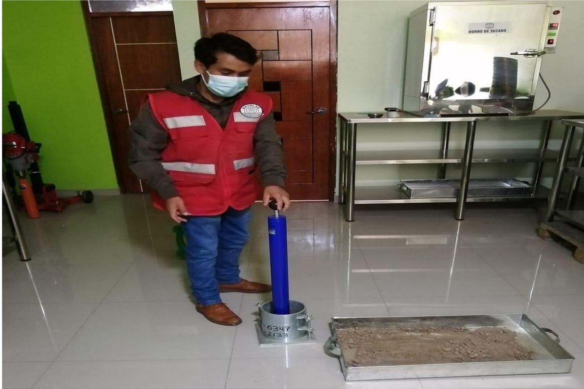
**Figura 30:** Se observa la compactación respectiva de la muestra Patrón.
