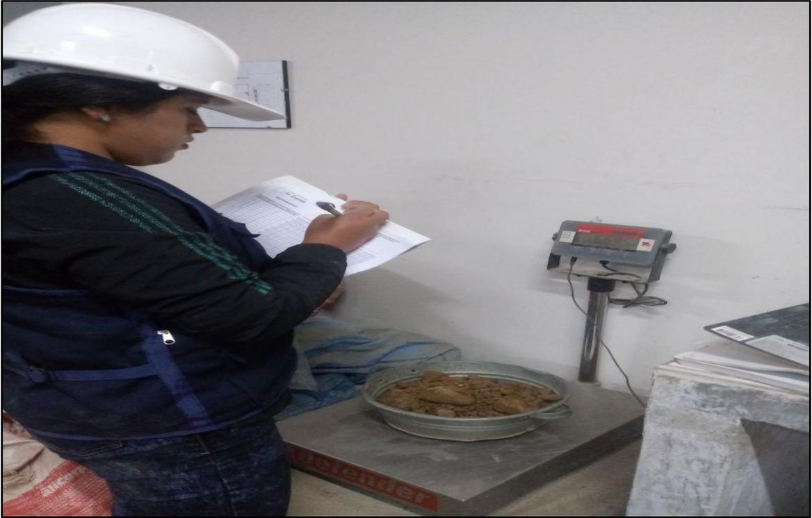
**Figura 23:** Se observa la toma de muestra de las partículas gruesas, para el posterior tamizado y análisis de resultados.
