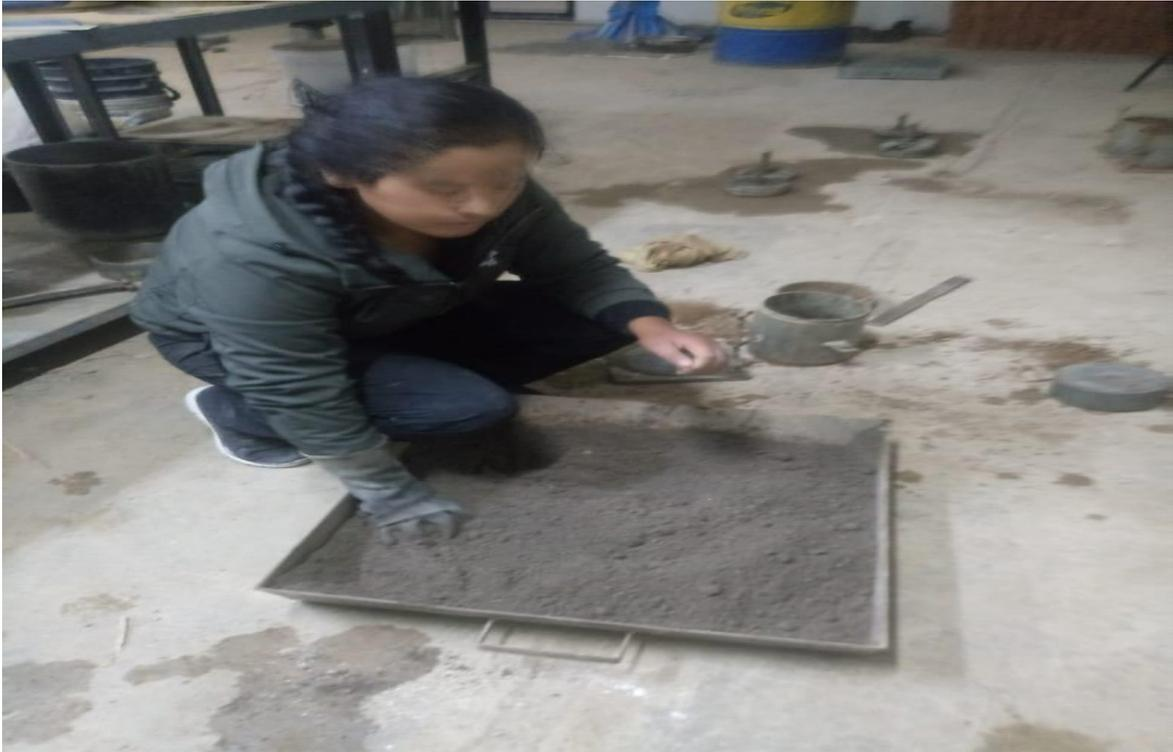
**Figura 34:** Se observa la combinación del suelo con la cal y CBCA, que se repite para ambos porcentajes de adición.
