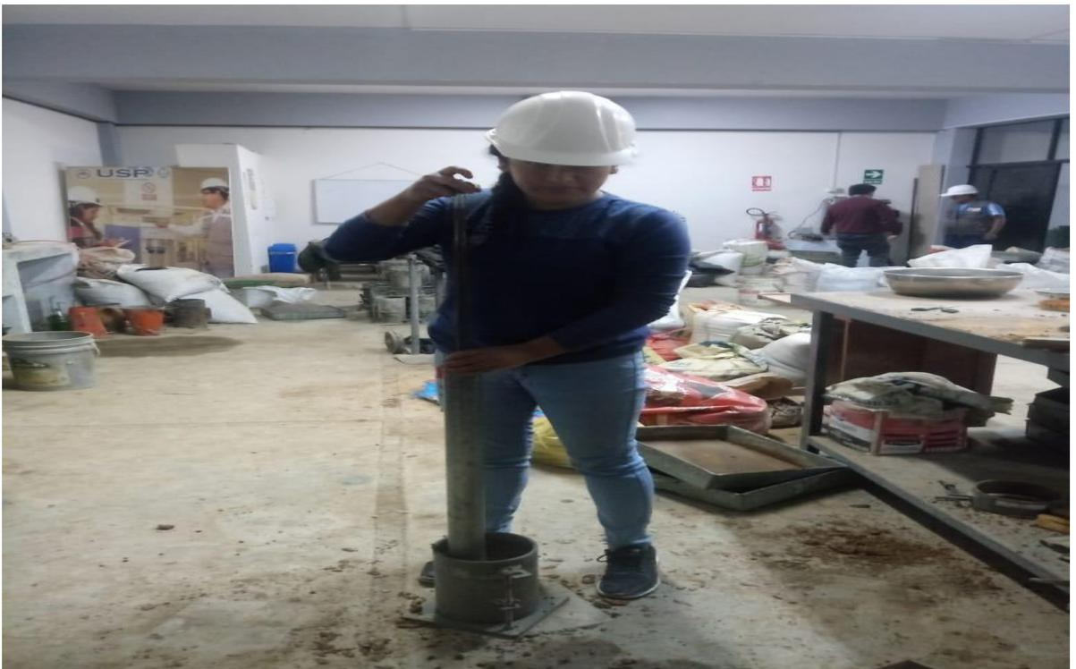
**Figura 33:** Se observa la compactación del ensayo CBR de la muestra Patrón.
