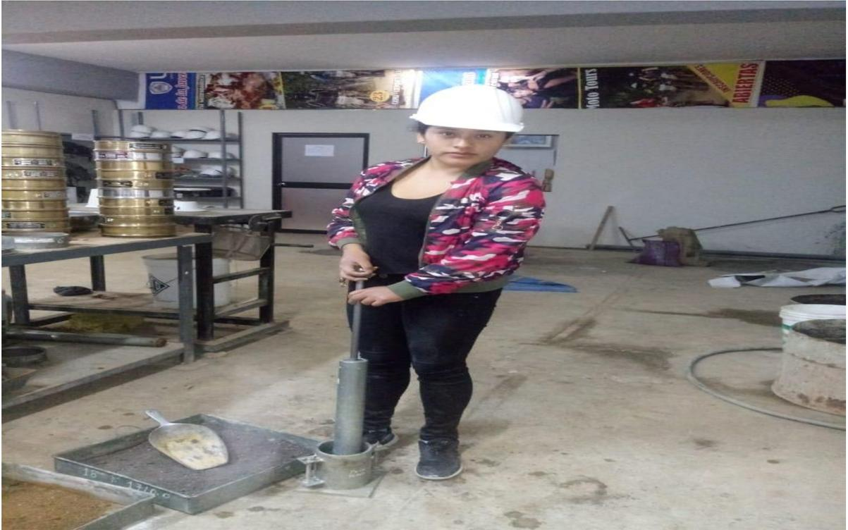
**Figura 32:** Se observa la compactación de la muestra con adición, procedimiento que se repite para ambos porcentajes de adición.
