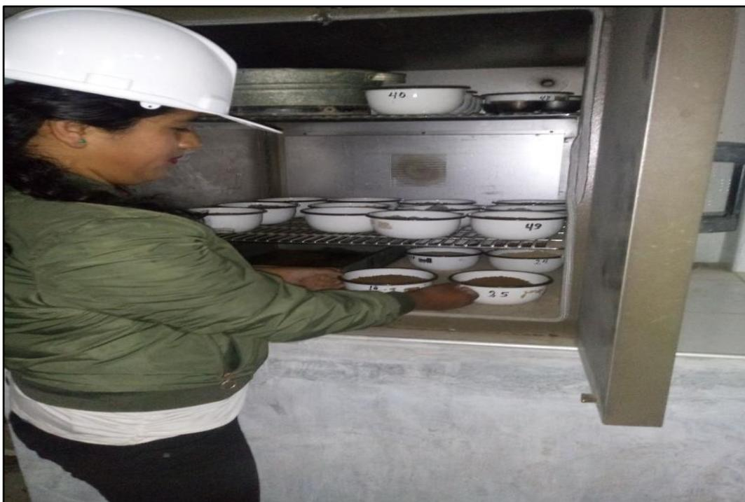
**Figura 21:** Llevado de la muestra al horno para el análisis del contenido de humedad del suelo en su estado natural.
