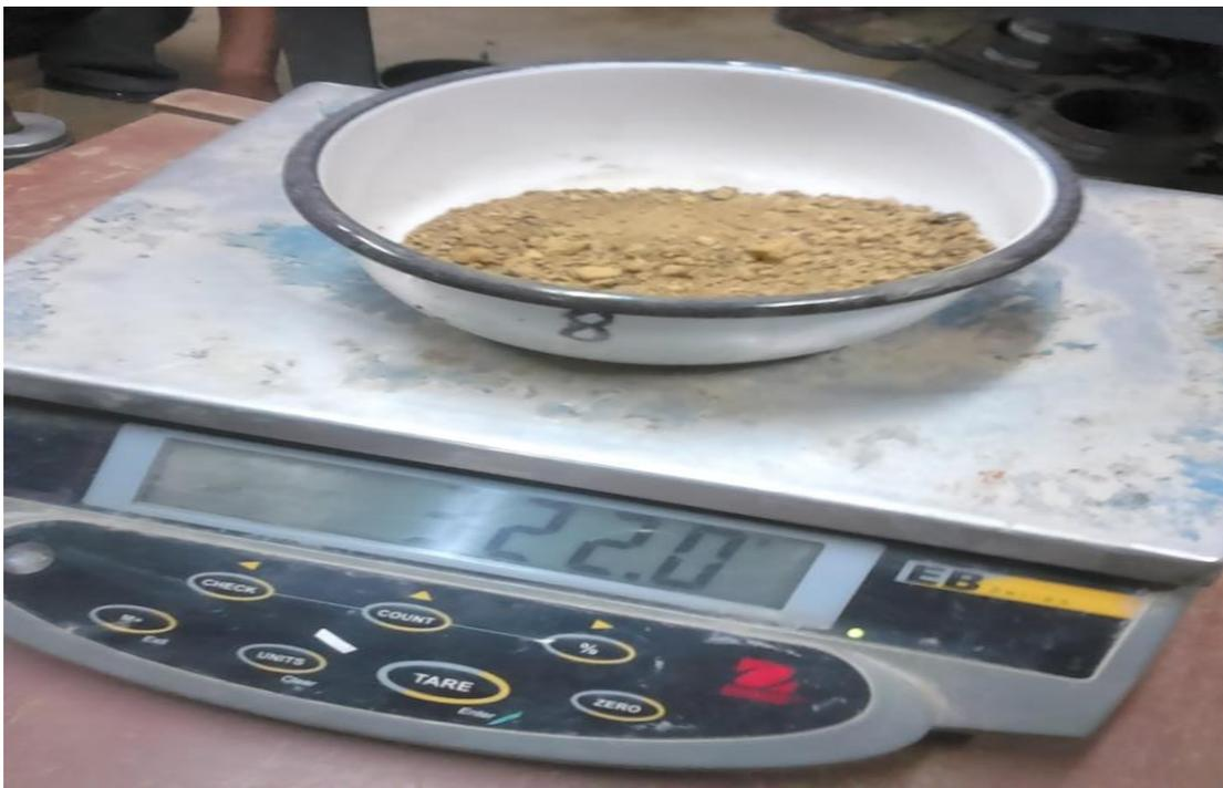
**Figura 29:** Se observa en ambas imágenes la obtención del contenido de humedad de la muestra antes de realizar el ensayo Proctor.
