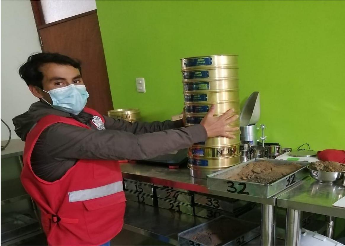
**Figura 27:** Se observa el tamizado respectivo de las partículas finas, luego del lavado y secado respectivo de la muestra.
