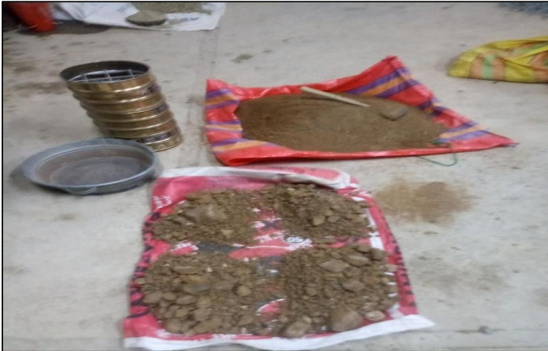
**Figura 20:** Se observa el cuarteo de la muestra, separado en partículas gruesas y finas respectivamente para el posterior ensayo granulométrico.
