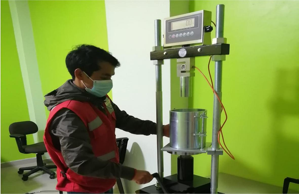
**Figura 36:** Se observa la manipulación de la máquina del CBR, y la anotación de los datos obtenidos en este ensayo.
