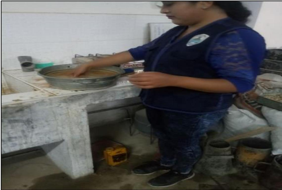
**Figura 24:** Se observa el lavado respectivo de las partículas finas del suelo, para su posterior ensayo granulométrico.
