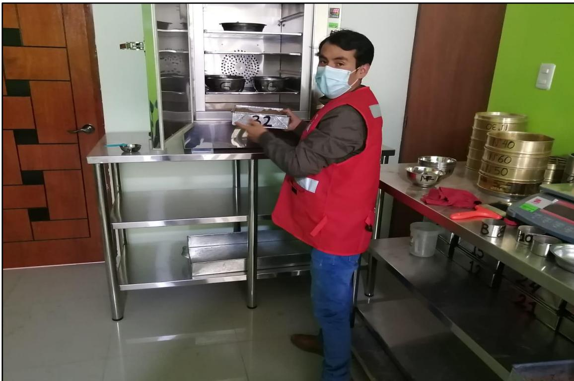
**Figura 25:** Extracción de la muestra lavada de suelo del horno. Después de 24 horas.
