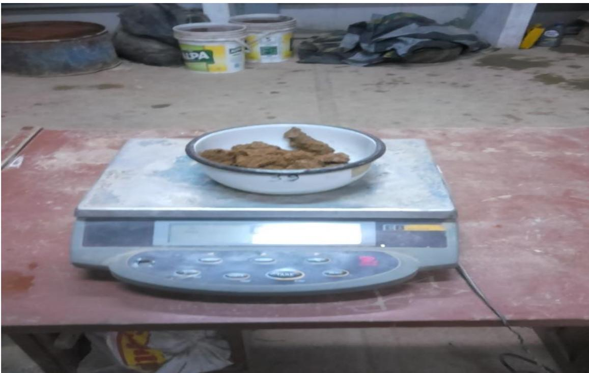
**Figura 37:** Se observa el pesado de la muestra que es extraída luego de que el molde sea sometido a la máquina de CBR, para obtener su contenido de humedad.
