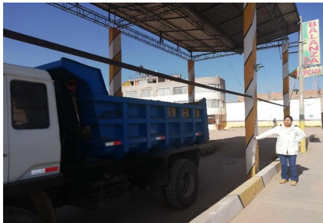
FOTOGRAFÍA N° 2 Control de peso del camión para ensayo de viga Benkelman
