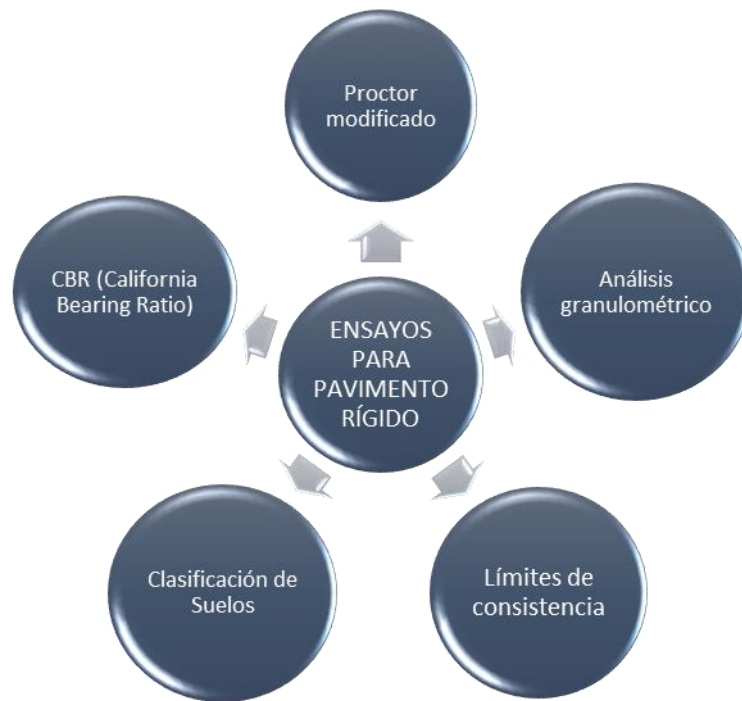
Figura 5. Ensayos para la evaluación estructural del pavimento rígido
