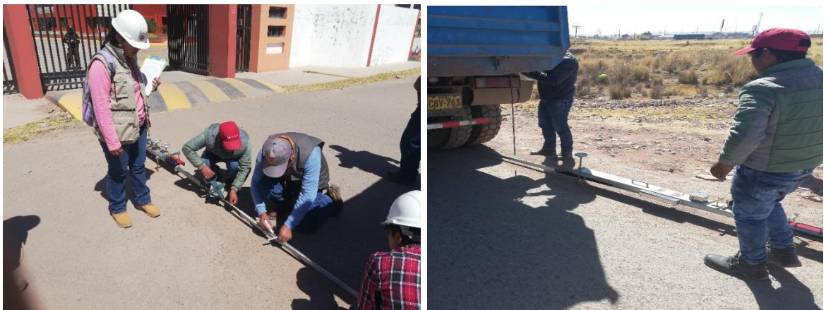
FOTOGRAFÍA N° 3 Armado del brazo para el ensayo de viga Benkelman
