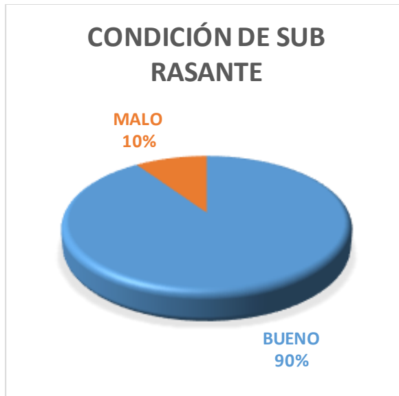
Figura 12: Porcentaje de la deflexión máxima que nos da la condición de la sub rasante del lado izquierdo de la vía
