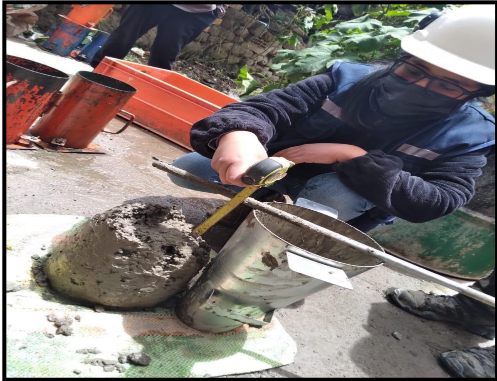
IMAGEN 03: MEDICION DEL SLUMP - TRABAJABILIDAD
