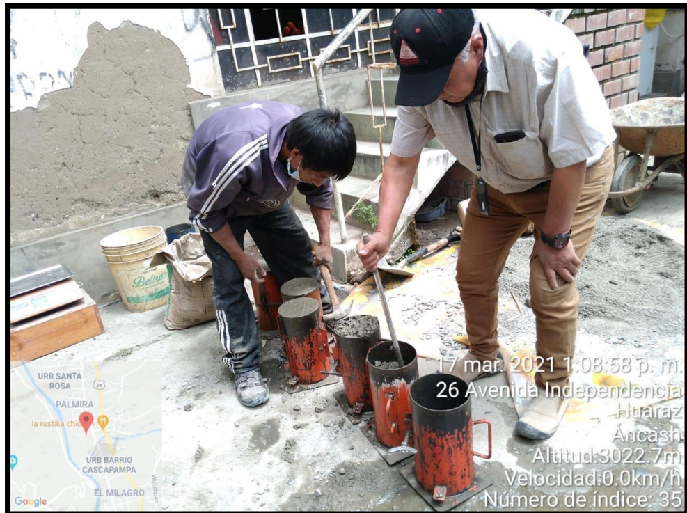
IMAGEN 04: TRES CAPAS DE MEZCLA 25 GOLPES CADA UNA
