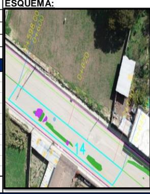
Recolección de datos, y determinación de la condición superficial del pavimento, Ud-18- carril derecho
