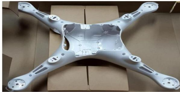
Figura 19 Estructura de VANT multirotor Phantom 4 Pro DJI
