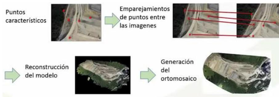
**Figura 27** Proceso de construcción del modelo
