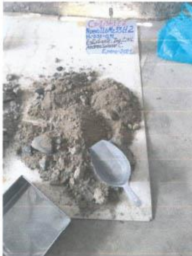
CLASIFICACIÓN DE MATERIAL DE MUESTRA DE CALICATA
