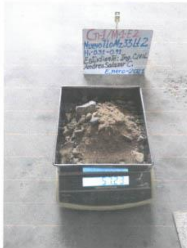
PESADO DE MATERIAL PARA TAMIZADO PARA GRANULOMETRÍA
