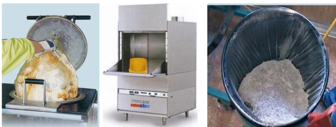
Figura 37. Residuos hospitalarios antes y después de ser tratados en el esterilizador
