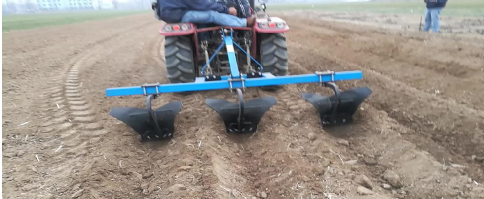
Figura 4. Implemento realizando surcos para sembrío.
