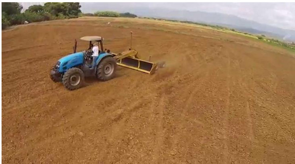
Figura 3. Implemento rufo nivelando el campo.
