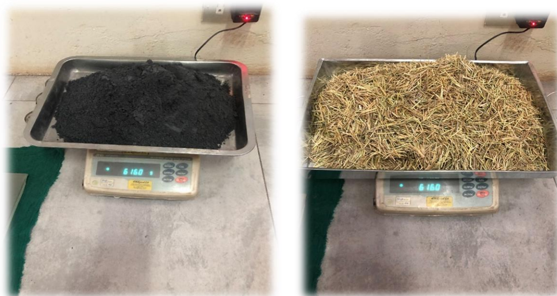
Fotografía 12. Peso del material en sus diferentes porcentajes 1%, 3% y 5%.
