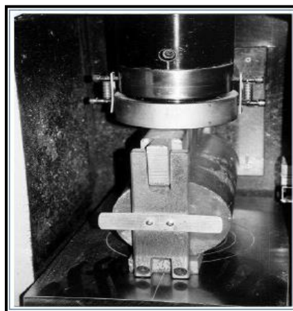
Figura 08. Cilindro colocado para ensayo de tensión indirecta.
