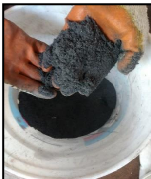
Figura 20. Tamizado de la Ceniza de rastrojo de cebada en el horno artesanal.
