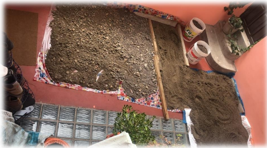
Fotografía 09. Secado de los materiales: Agregado grueso y agregado fino.
