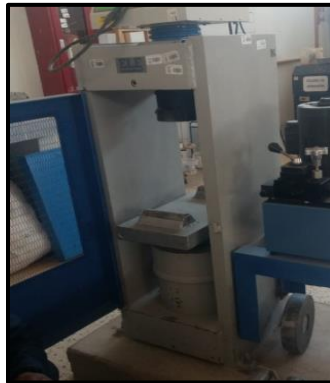
Figura 12. Resistencia a flexión de las vigas de hormigón ASTM C78
