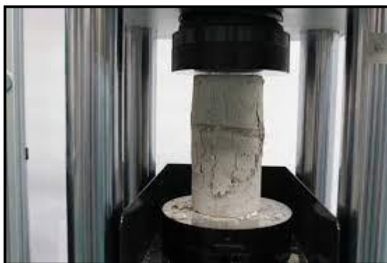
Figura 04. Ensayo de Resistencia a compresión.
