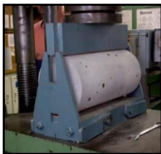
Figura 33. Ensayo a tracción indirecta en vigas.
