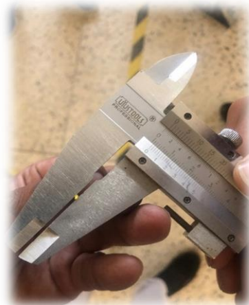
Fotografía 05. Medición fibra de Chillihua.
