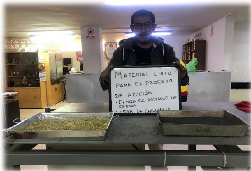
Fotografía 11. Material listo para el proceso de adicción a la mezcla para los testigos.
