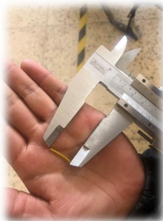
Fotografía 05. Medición fibra de Chillihua.
