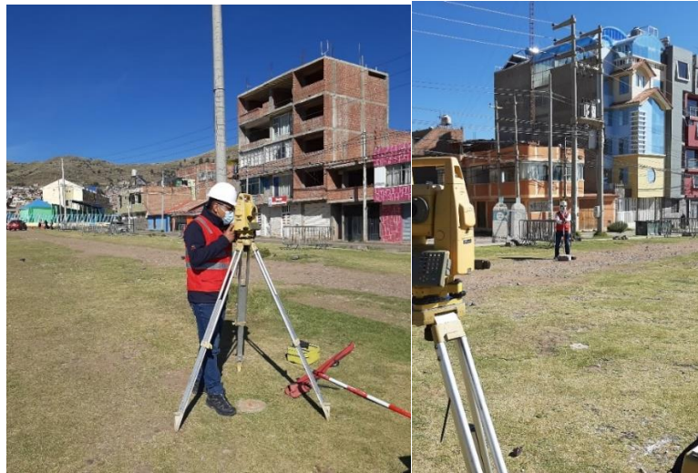
Figura 41. Determinación de Norte, Este y Altitud con Estación total
